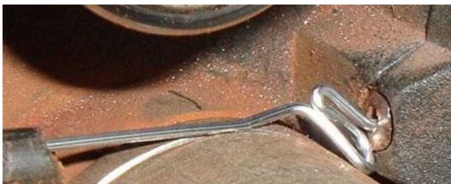
Рисунок 1.9 – Смятие алюминиевой проволоки в механизме подачи
