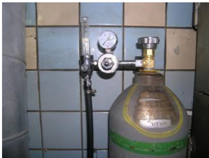
Рисунок 1.4 – Баллон для аргона, укомплектованный поплавковым ротамером и редуктором
