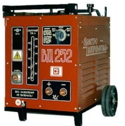
Рисунок 1.8 – Применяемый по базовой технологии выпрямитель сварочный ВД-252
