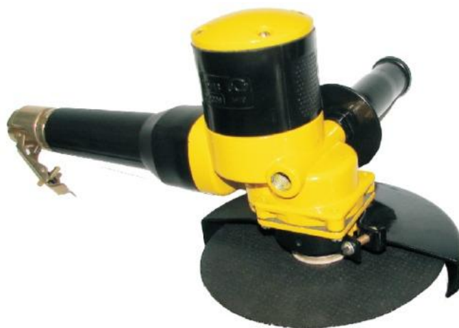
Рисунок 1.7 – Применяемая по базовой технологии шлифовальная машина ИЭ-2106
