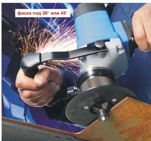
Рисунок 1.5 – Применяемая в базовой технологии ручная кромкофрезерная машина ЕКФ 300
