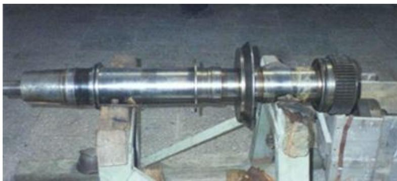
Рисунок 1.4 – Вал нагнетателя газа перед восстановлением посадочных поверхностей
