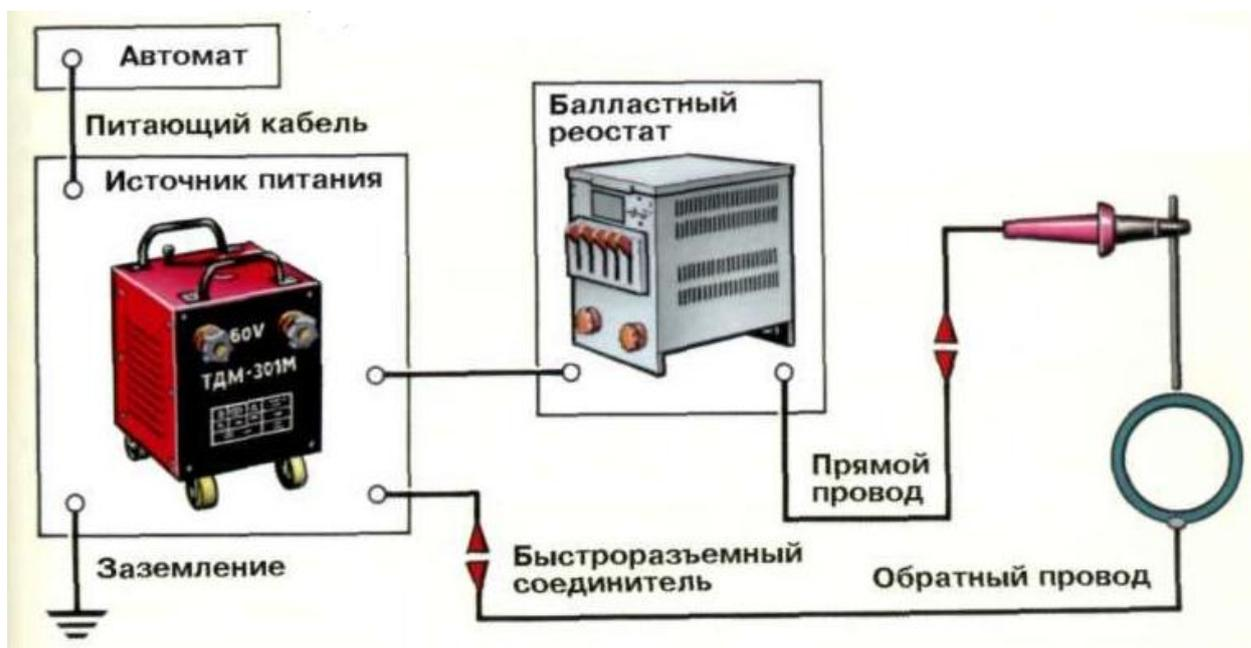
Рисунок 1.7 – Схема процесса ручной дуговой наплавки
