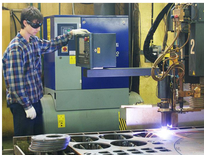
Рисунок 1.1 – Автоматизированная линия плазменной резки
