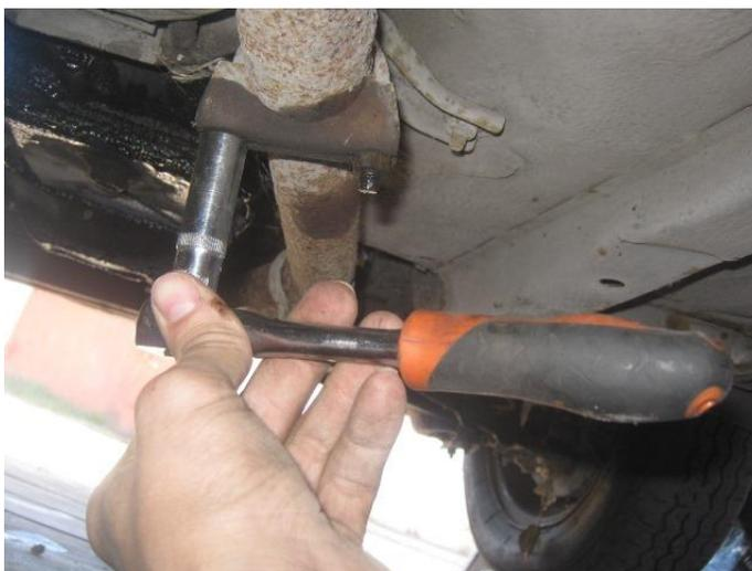
Рисунок 2.1 – Откручивание гаек крепления хомута
