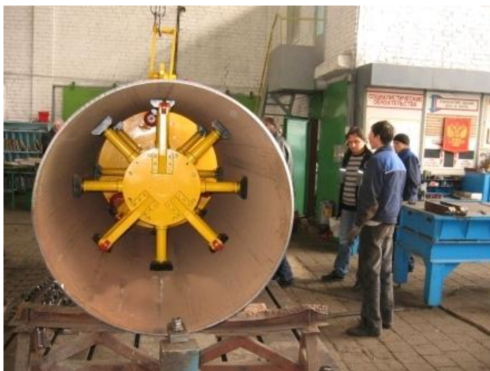
Рисунок 2.7 – Оборудование для разделки кромок труб – станок СПК 1423
