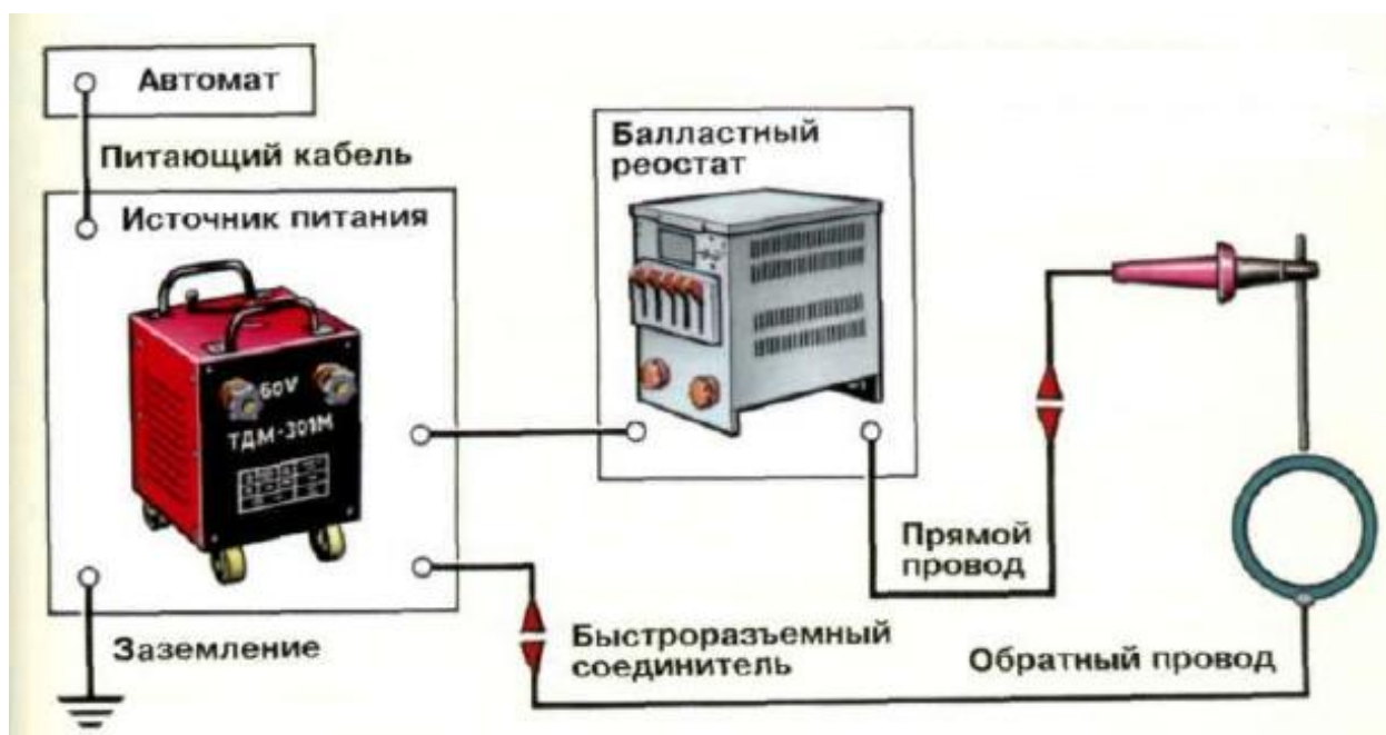
Рисунок 2.1 – Схема сварочного поста для ручной дуговой сварки покрытыми электродами
