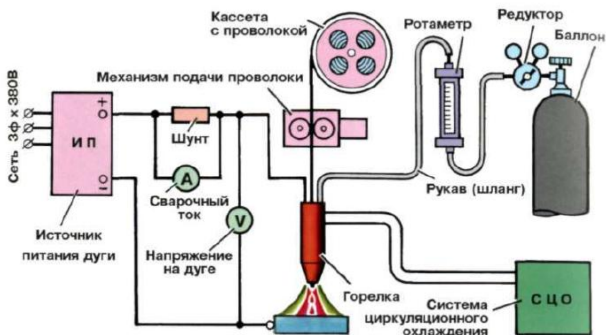
Рисунок 2.2 – Схема сварочного поста для механизированной сварки в среде защитного газа
