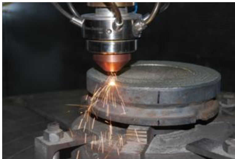
Рисунок 1.9 – Общий вид процесса лазерной наплавки тарелок задвижки узла запорной арматуры DN 200
