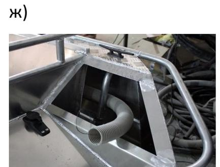
Рисунок 1.2 – Изготовление корпуса алюминиевых катеров и лодок
