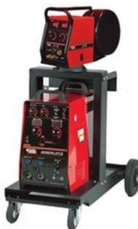
Рисунок 3.4 – Внешний вид сварочного инвертора с подающим механизмом
