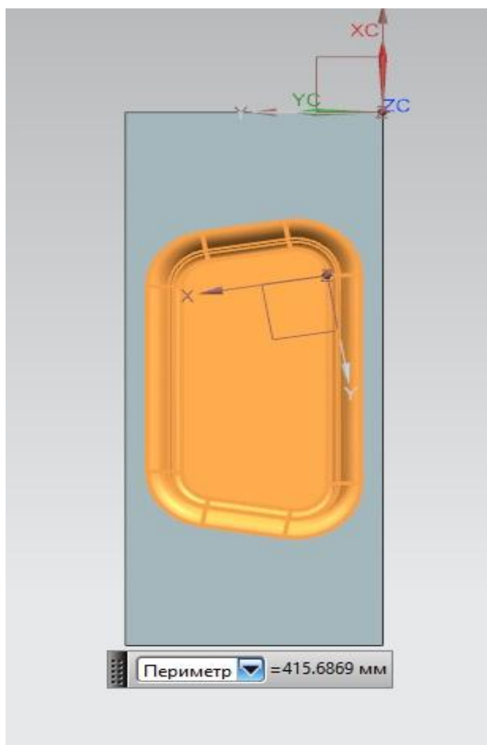
Рисунок 2.7 – Периметр вытягиваемой заготовки на операции 40
