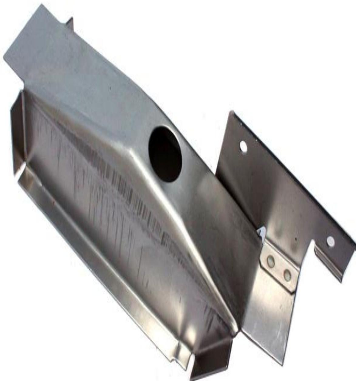
Рисунок 1.1-Соединитель порога лонжерона
