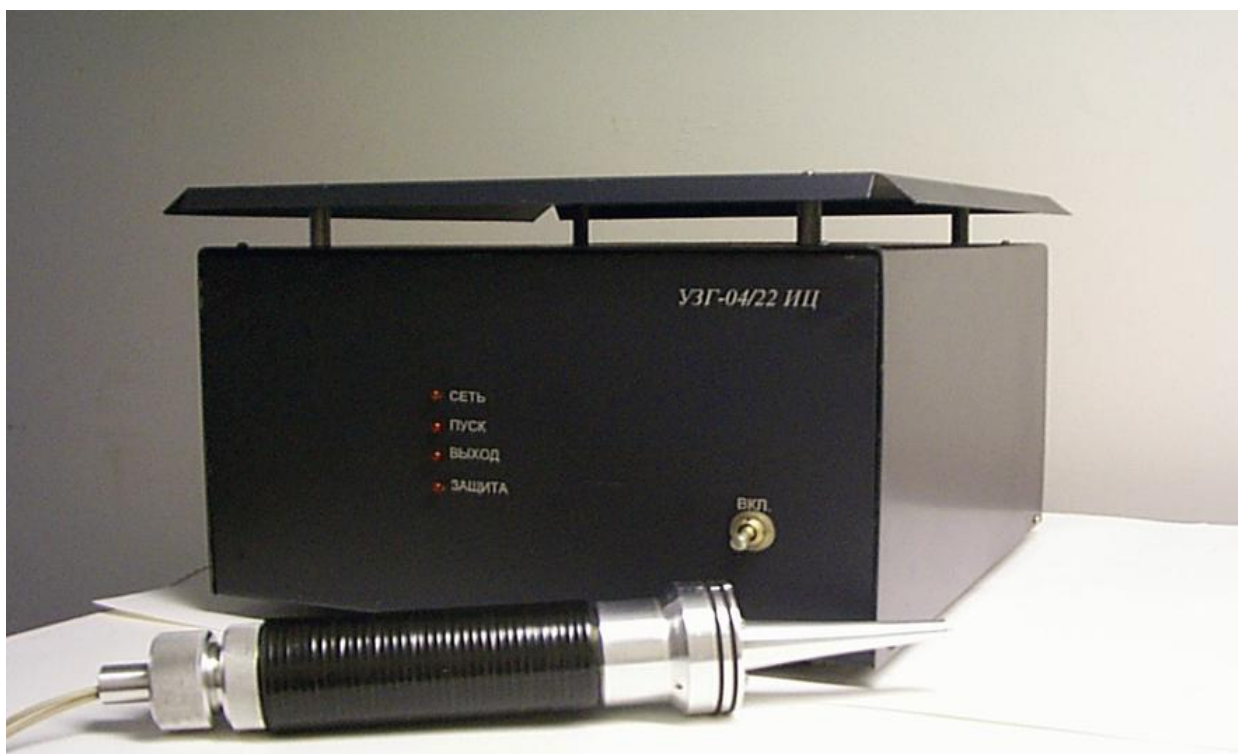
Рисунок 1.1 – Ультразвуковой комплекс для сварки пластмасс
