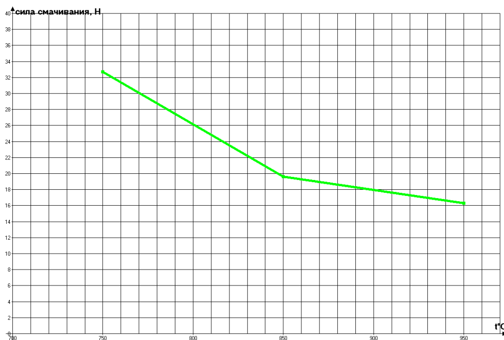
Рисунок 3.5 – график зависимости силы смачивания от температуры
