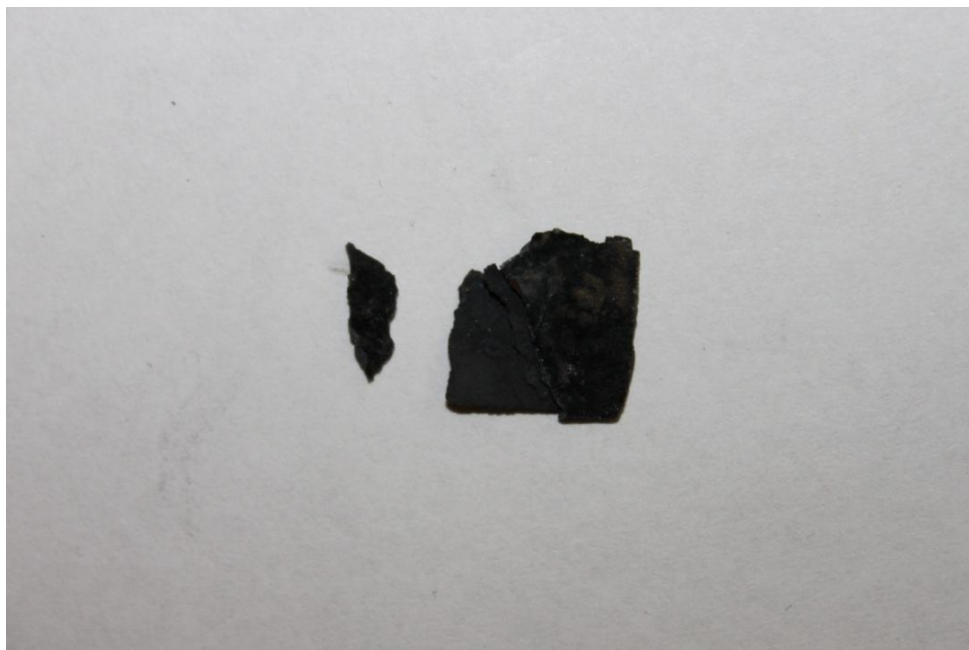
Рисунок 3.14 - Сталь без алитирования после 500ч в печи сопротивления
