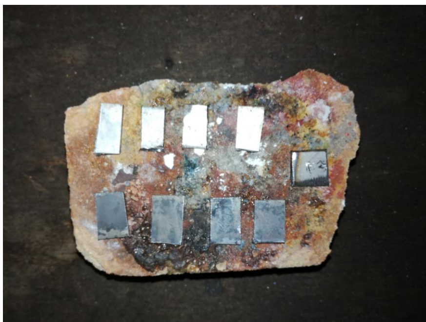
Рисунок 3.10 - Образцы перед погружением в печь
