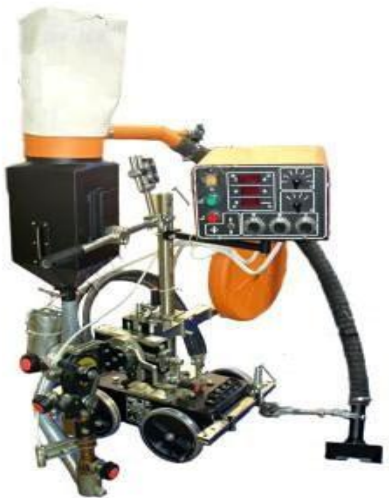
Рисунок 1.12 - Сварочная установка АДФ-1000
