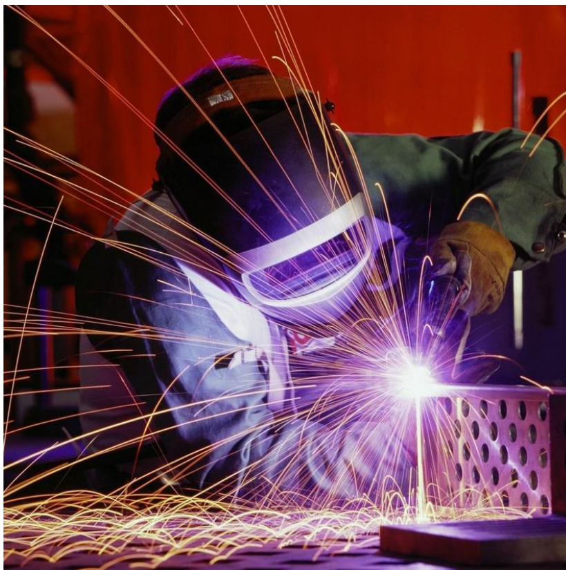
Рисунок 2.2 - Выполнение ручной дуговой сварки
