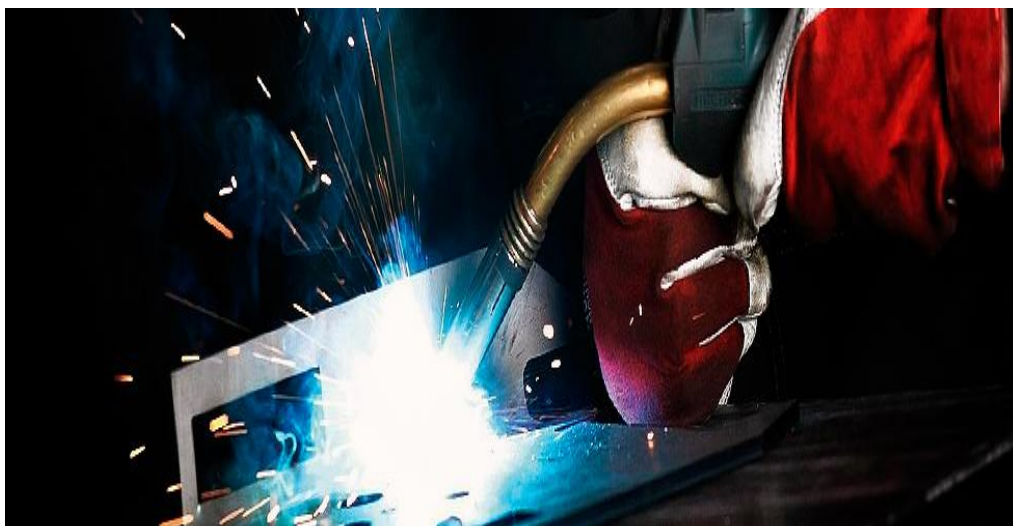
Рисунок 2.3 - Механизированная сварка в среде защитных газов
