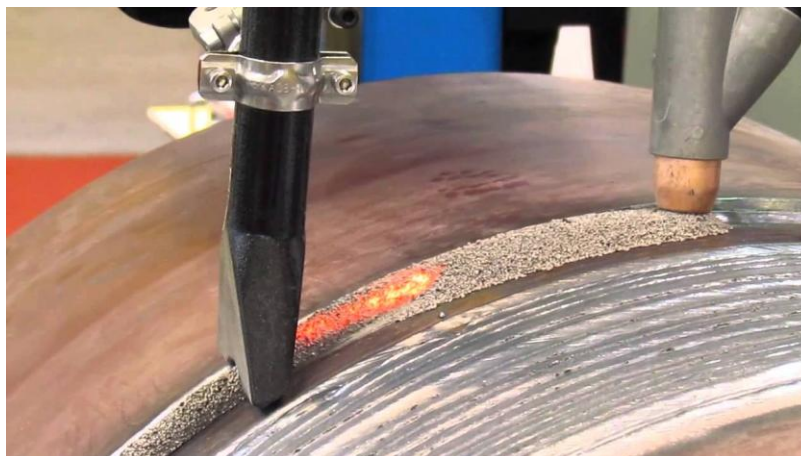
Рисунок 1.9 - Автоматическая сварка под флюсом
