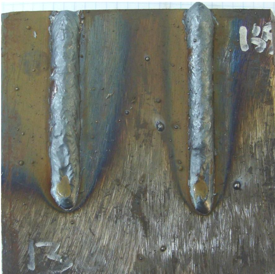
Рисунок 21 – Сварка проволокой 1,6 мм
