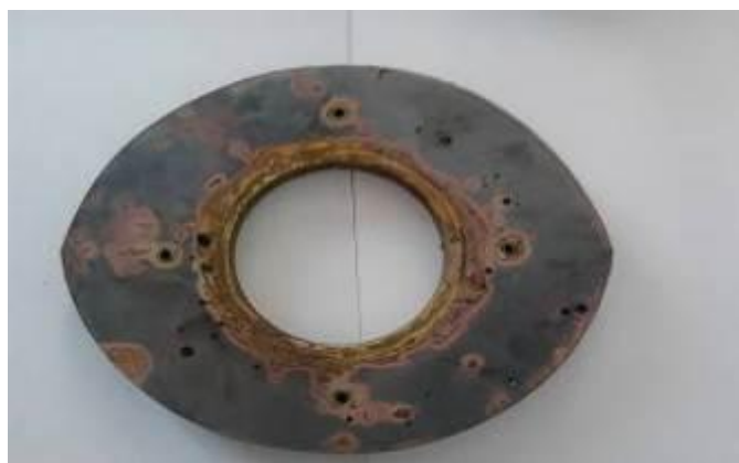
Рисунок 2.10.2 – Второй паяный образец ротора
