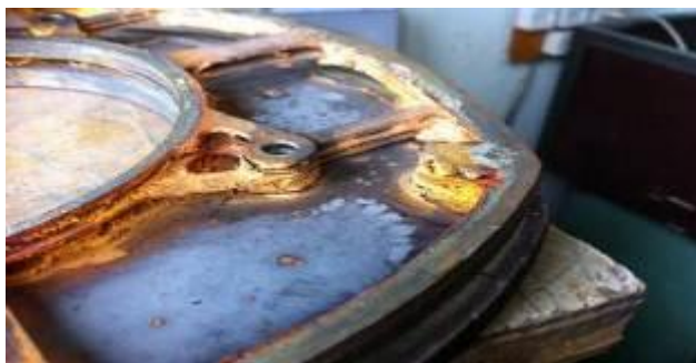
Рисунок 2.10.1 – Первый паяный образец ротора
