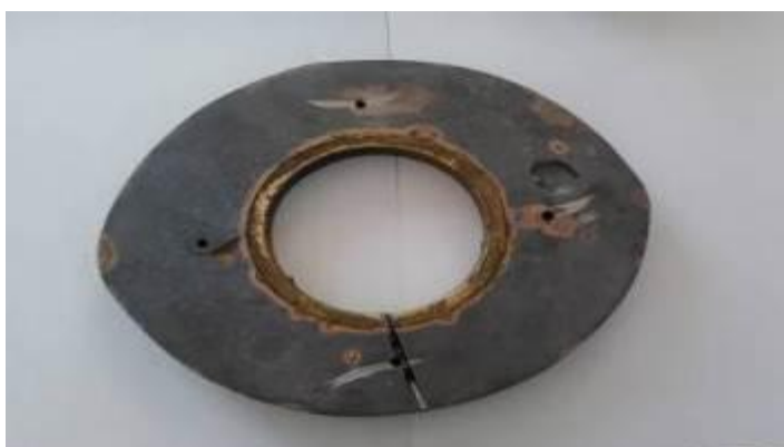
Рисунок 2.10.3 – Третий паяный образец ротора
