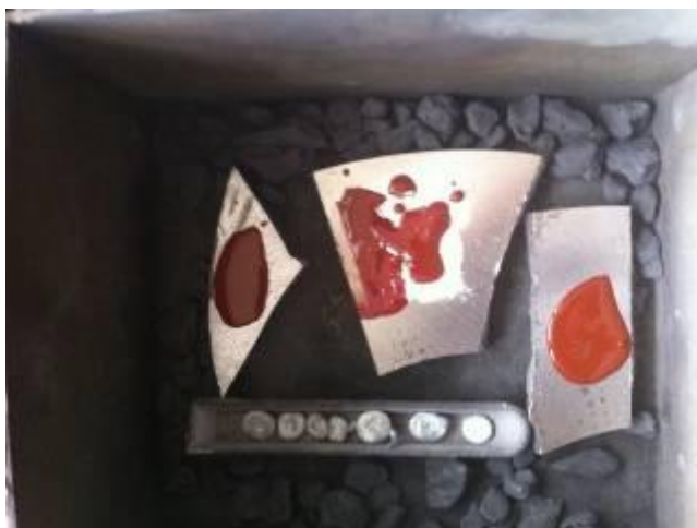
Рисунок 2.6 – Образцы с нанесенной паяльной пастой ППВС перед нагревом
