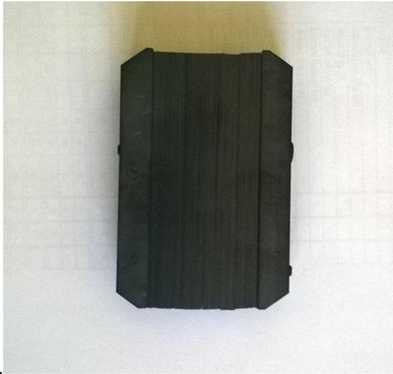
Рисунок 2.2.2 - Магнитострикционный пакет в сборочном приспособлении
