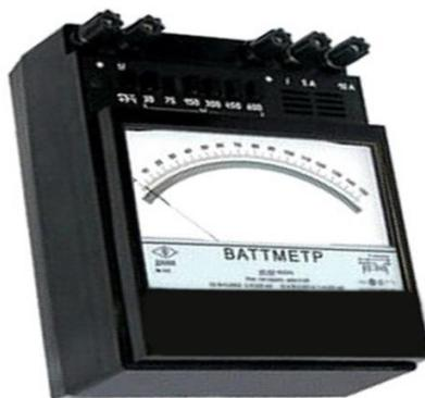
Рисунок 2.3 – Ваттметр для измерения мощности дуги в сварочной цепи
