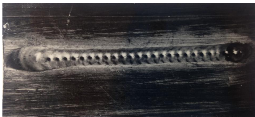
Рисунок 1.4 – Продольный шов при сварке в импульсном режиме без перекрытия точек
