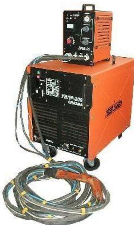
Рисунок 8 – Установка воздушно – плазменной резки УВПр-200
