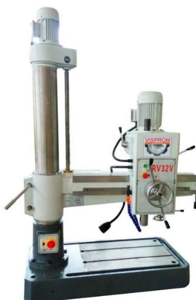
Рисунок 6 - Радиально-сверлильный станок Proma RV-32
