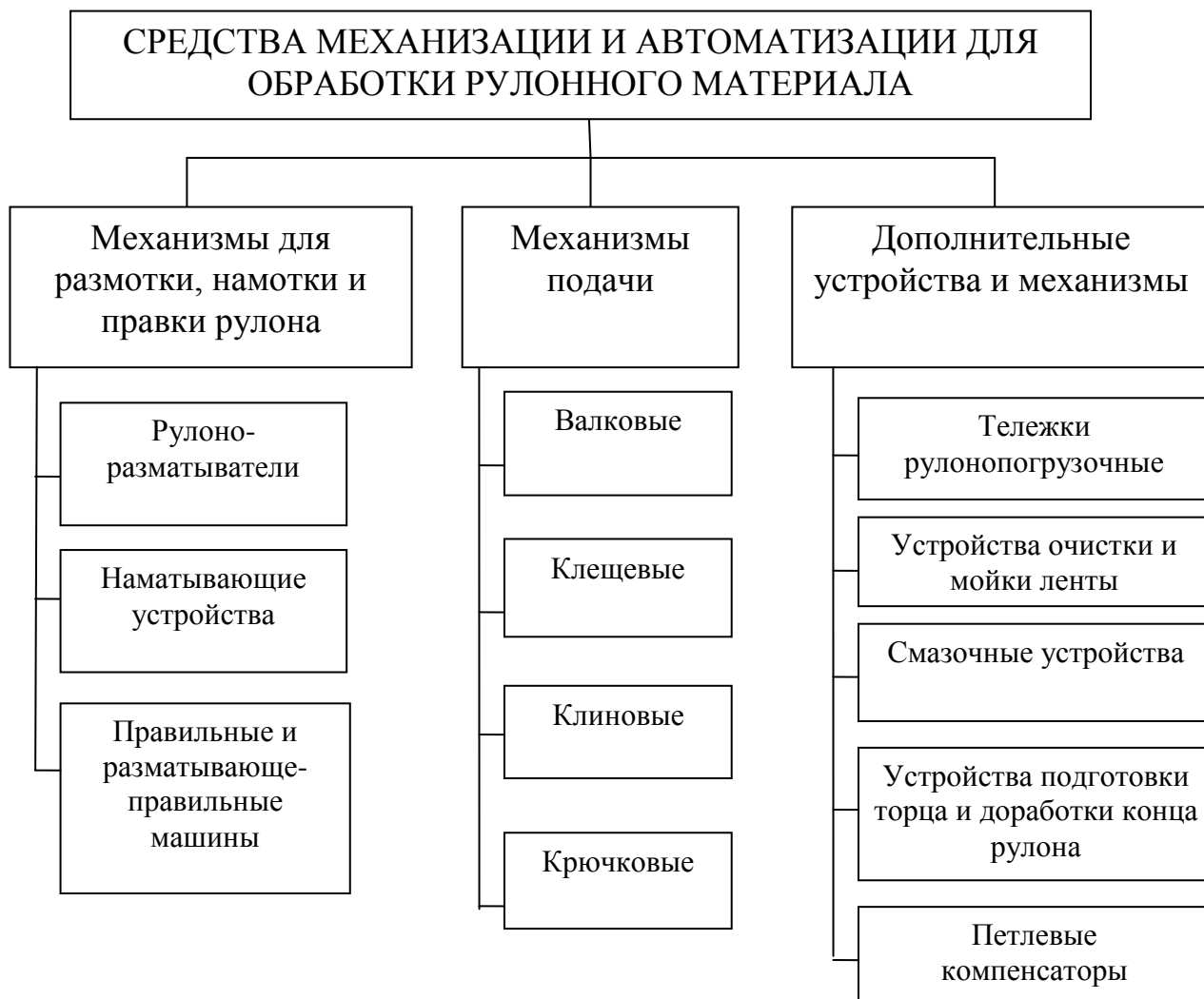
Рисунок 3.3 – Схема классификации механизмов для обработки рулонного материала
