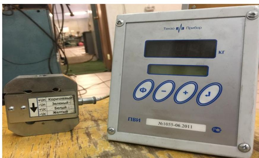
Рисунок 4.4 – Электрический динамометр
