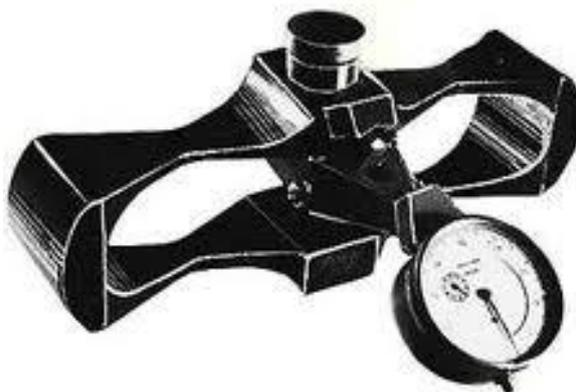
Рисунок 4.1 - Механический динамометр
