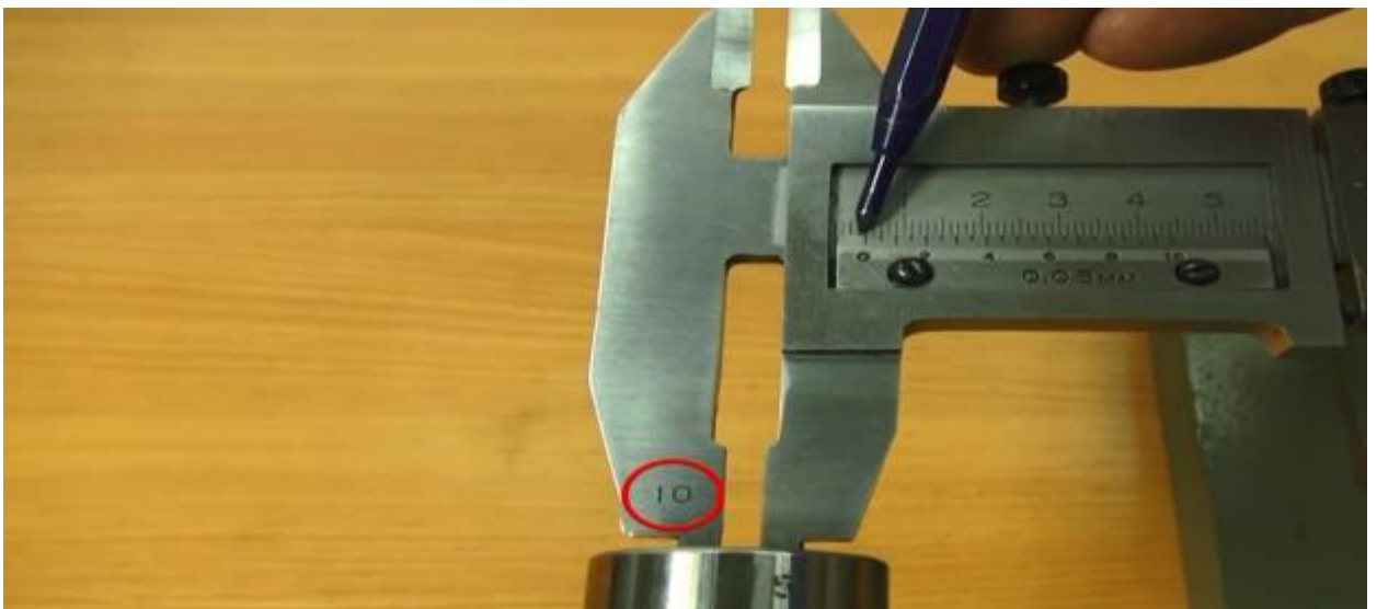
Рисунок 22 – измерения внутренних размеров ШЦ 2 и ШЦ 3
