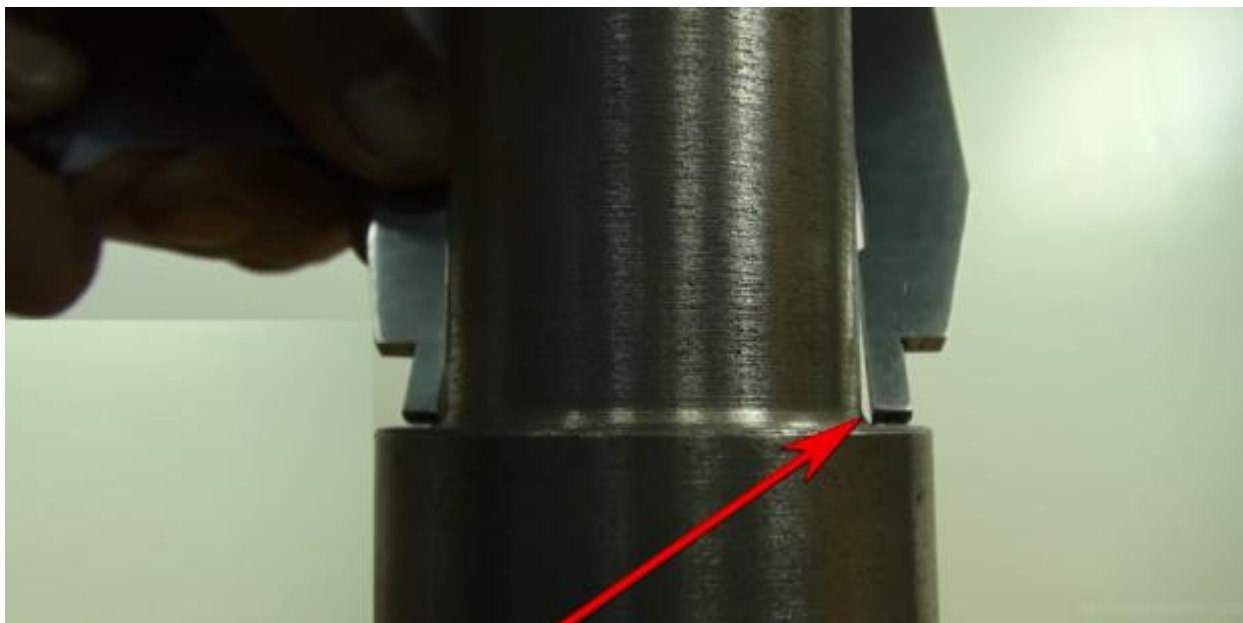
Рисунок 34-Радиусы в углах уступов
