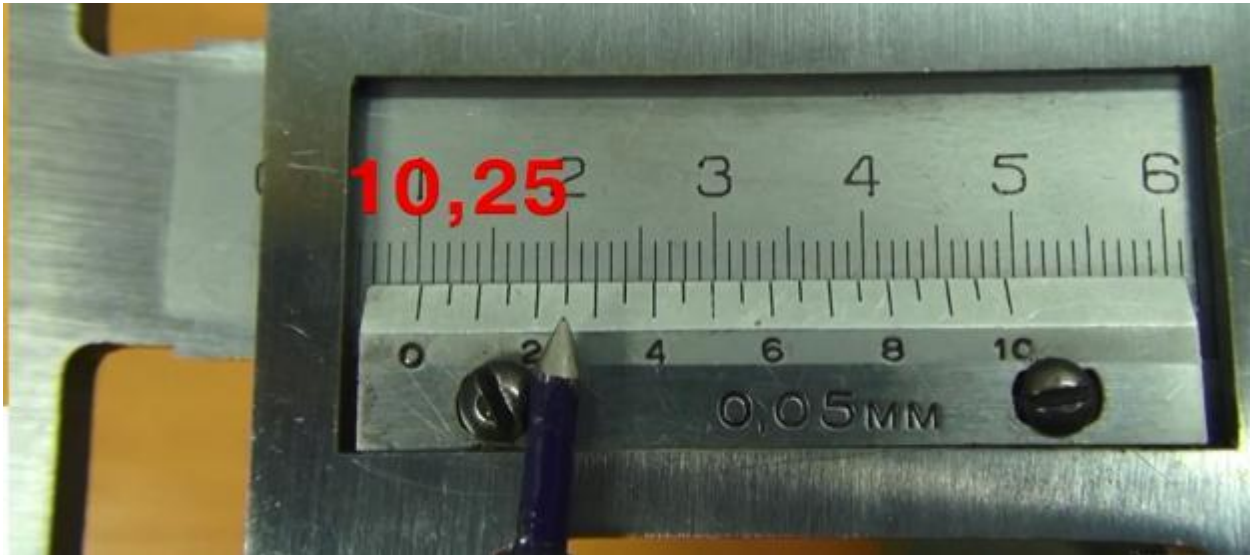
Рисунок 21 - считывание размеров на нониусных штангенциркулях
