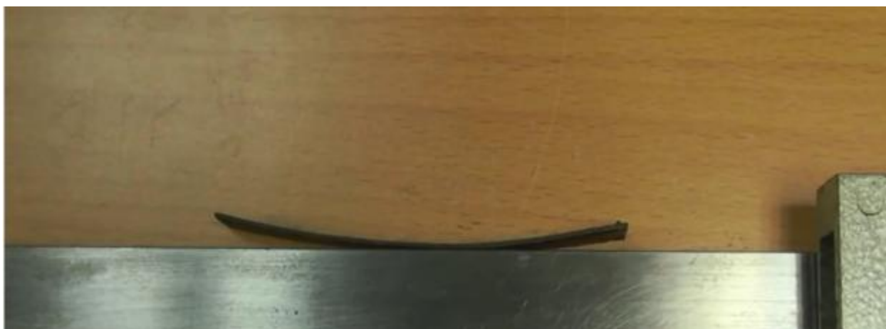
Рисунок 25 - Пружина, установленная в рамке, с выгибом к штанге
