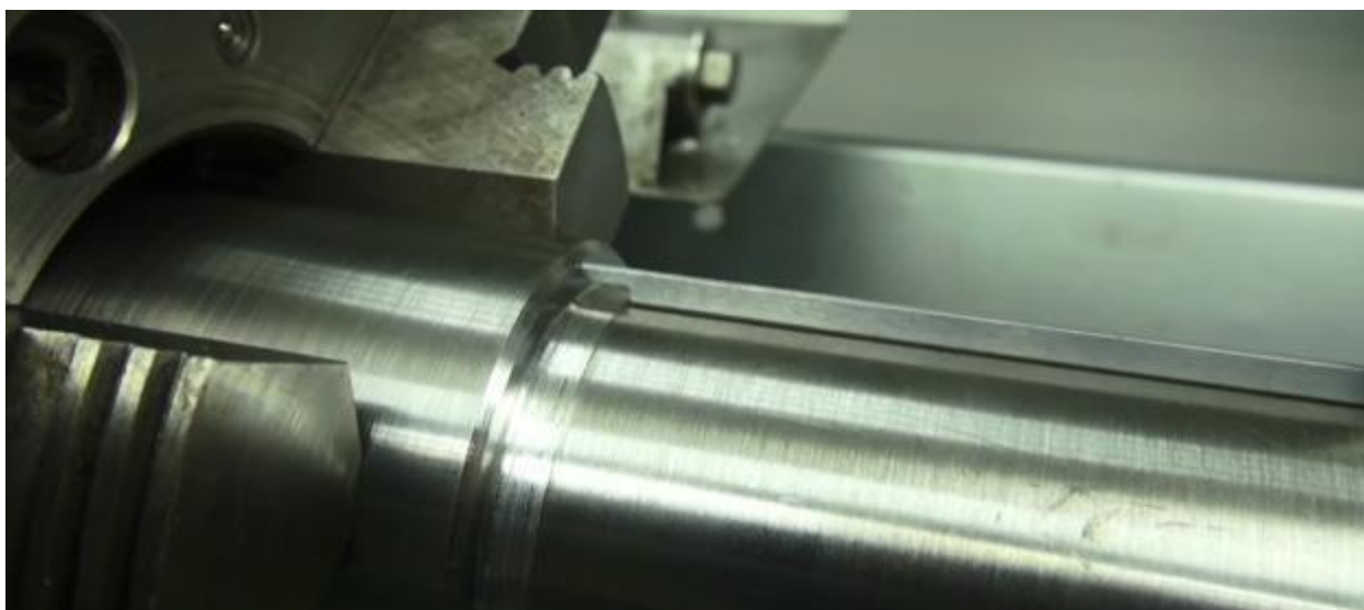
Рисунок 36 – Вырез на глубиномере
