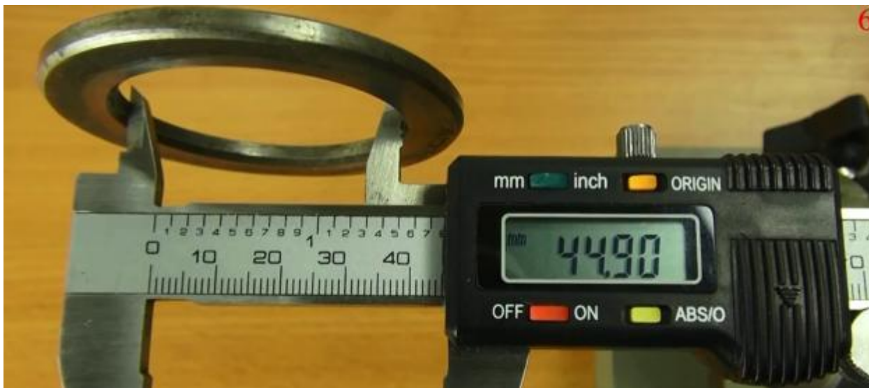
Рисунок 19 - считывание размеров на цифровых штангенциркулях
