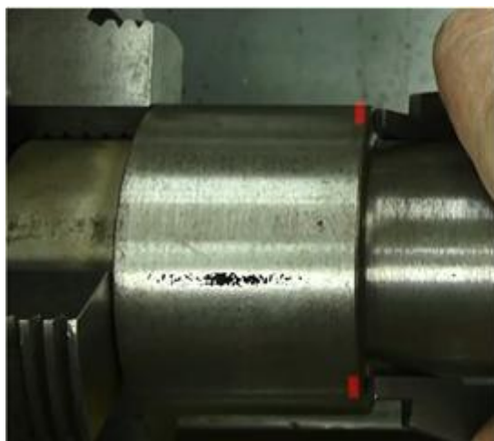
Рисунок 29 - Равномерное опирание губок
