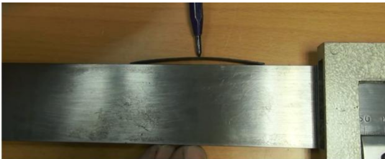
Рисунок 24 - Пружина, установленная в рамке, с выгибом от штанги
