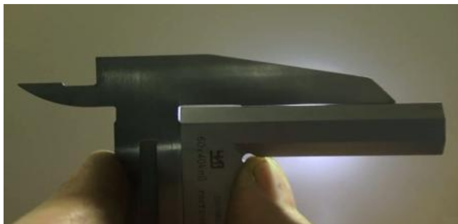
Рисунок 23 – Проверка и регулировка штангенциркуля
