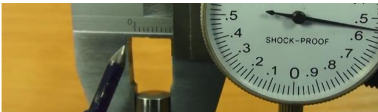
Рисунок 20 - считывание размеров на штангенциркулях типа ШЦК
