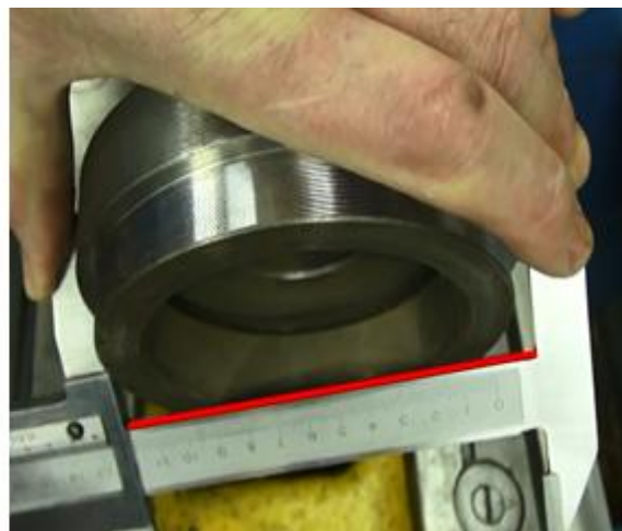
Рисунок 29 - Равномерное опирание губок
