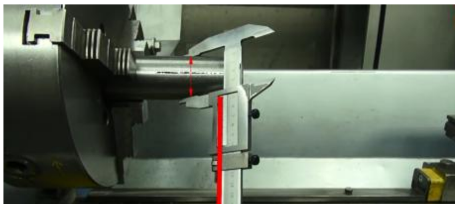
Рисунок 28 - Наклон плоскости штангенциркуля
