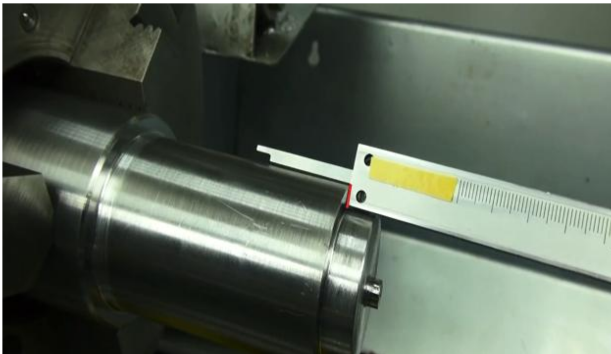
Рисунок 35 -Измерение глубин и удалённостей уступов
