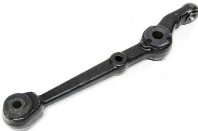
Рисунок 2 – Рычаг передней подвески автомобиля ВАЗ 2108
