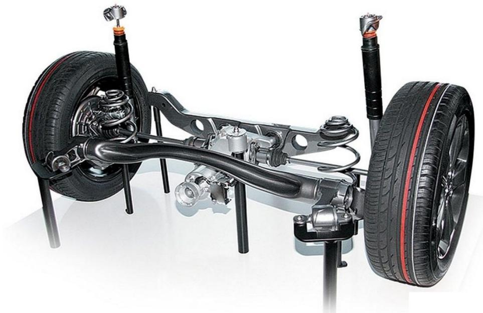
Рисунок 5 – Задняя подвеска автомобиля Opel Mokka 4x4
