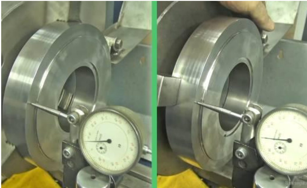
Рисунок 3.2 - Связь положения оси вращения шпинделя с направлением подач станка
