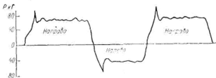
Рис. 1.11 — Кривая, описанная динамометрической тягой, встроенной в привод воздухораспределителя пневматического усилителя
