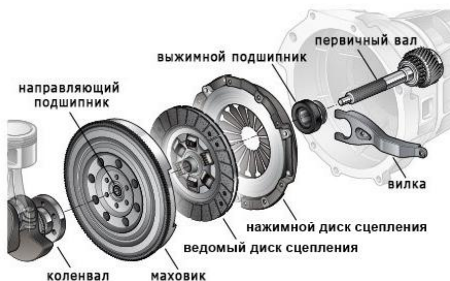
Рисунок 1.1 - Компоненты сцепления
