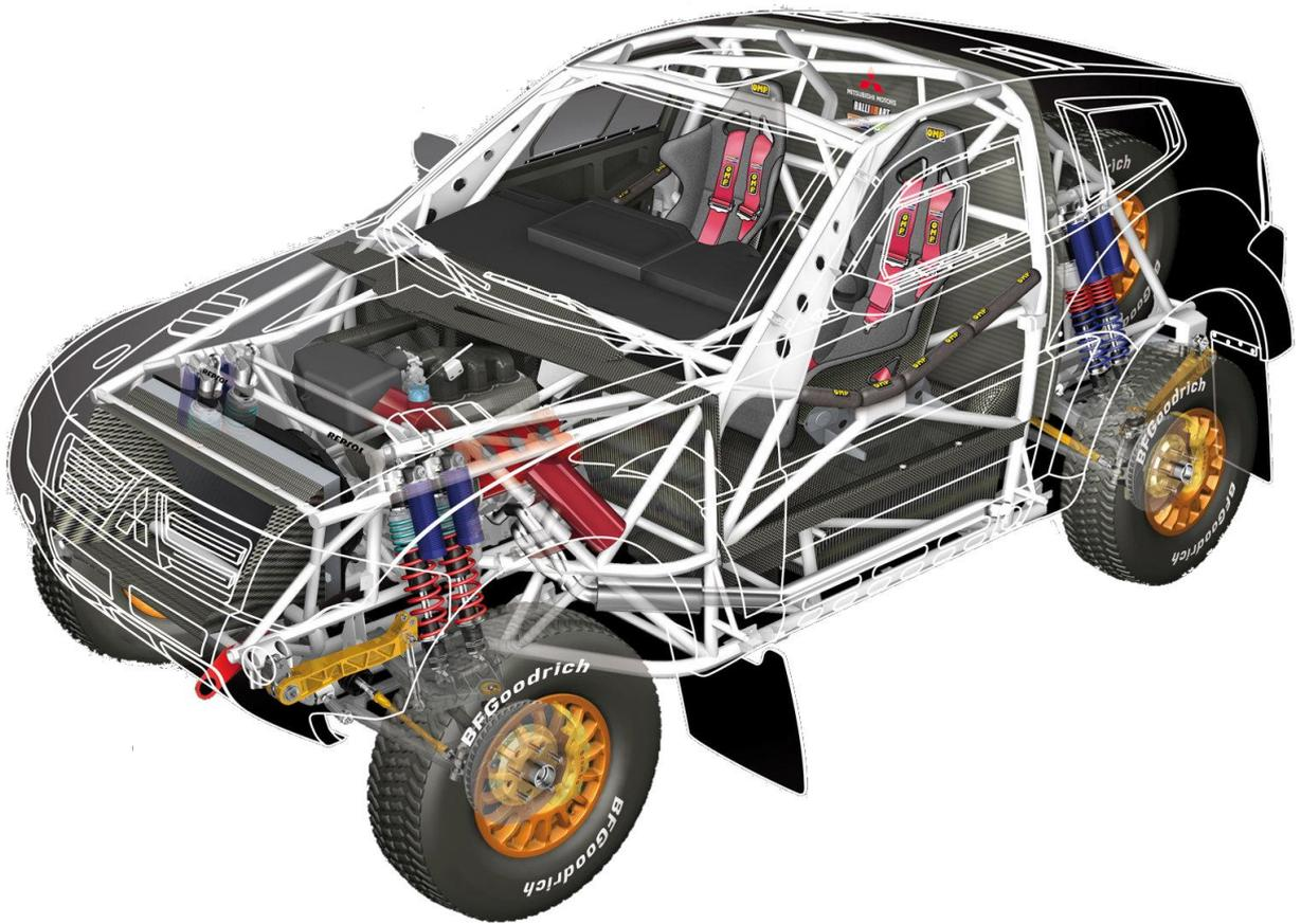
Рис. 7 Несущая система гоночного автомобиля Митсубиси Паджеро
