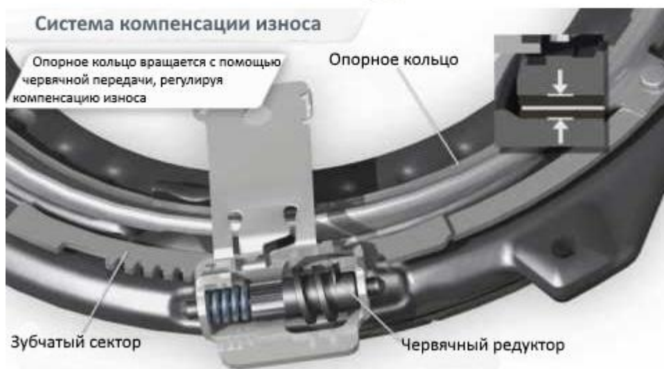
Рисунок 1.5 – Особенности конструкции саморегулирующегося сцепления SAT
