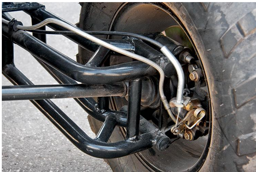
Рисунок 1.11 - Подвеска на двойных продольных рычагах
