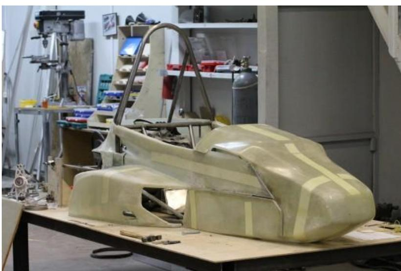
Рисунок 1.4.6 – Процесс примерки макета на раму болида
