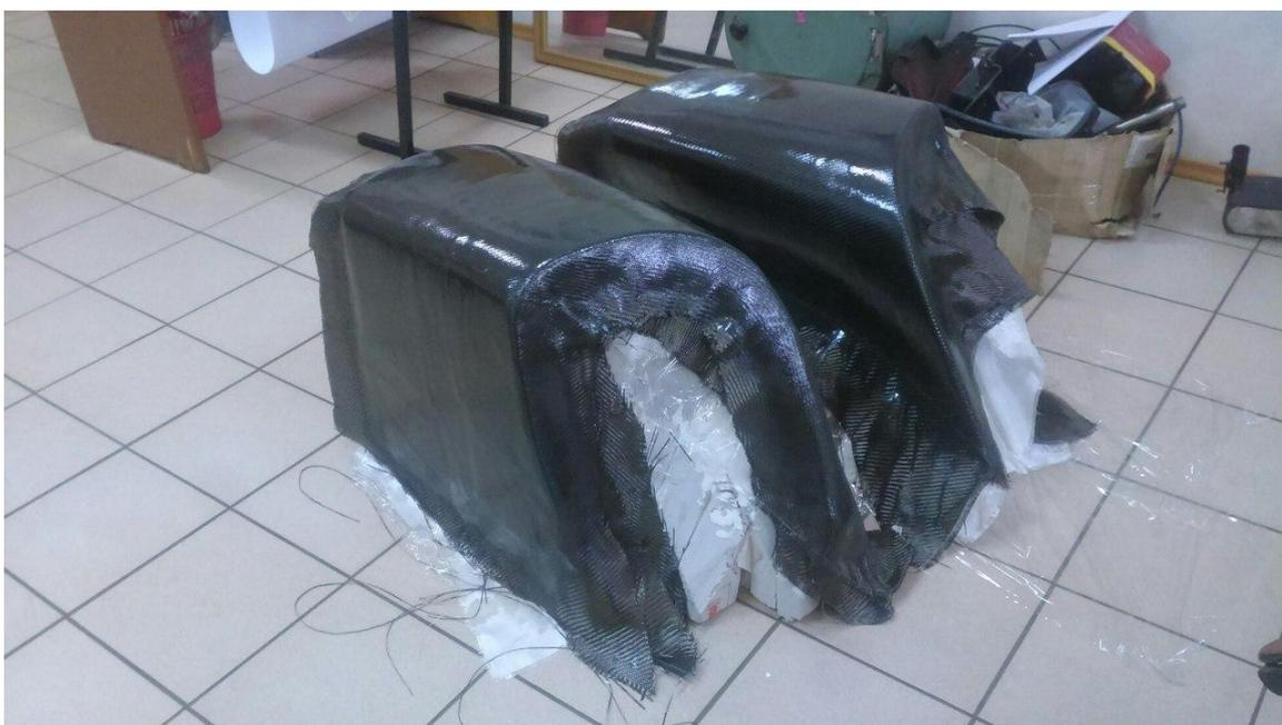
Рисунок 1.4.5 - «Жабры» болида, на матрице лежит три слоя углеткани и в течение 1 дня идет процесс «сушки» и затвердевания
