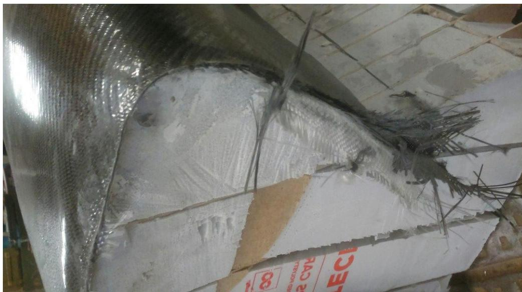
Рисунок 1.4.4 - Матрица, покрытая тремя слоями углеродной ткани
