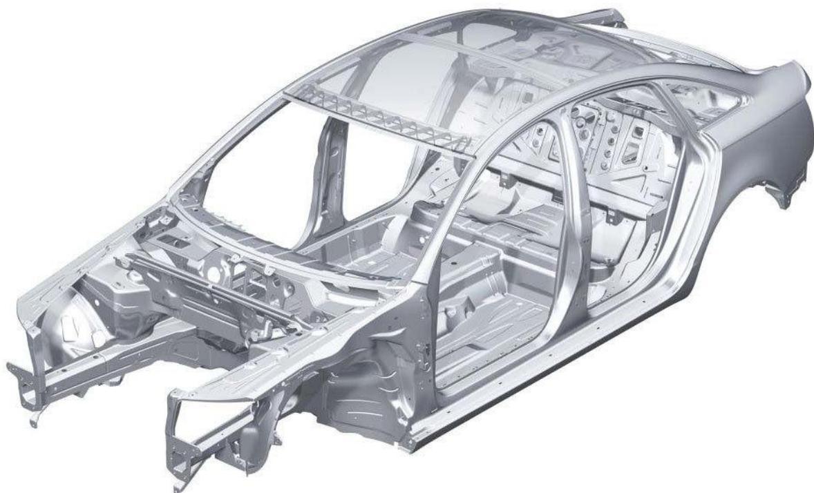
Рисунок 1.1 – Кузов автомобиля
