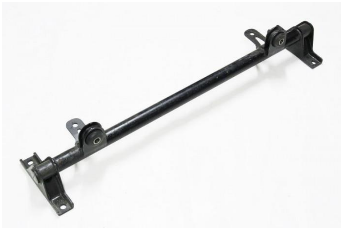
Рисунок 3 - Поперечина передней подвески (балка) на автомобиль ВАЗ 2110/Лада-Приора
