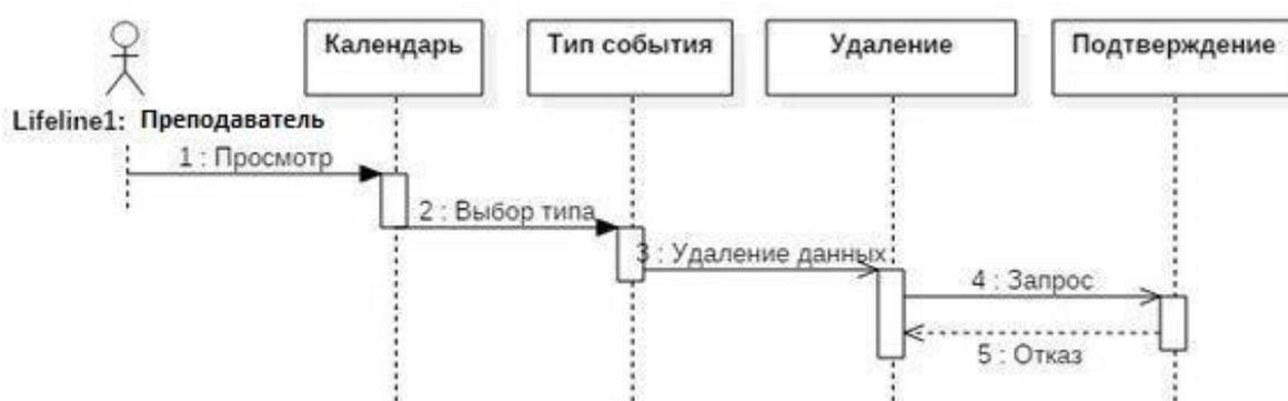
Рисунок 3.24 – Диаграмма последовательности для удаления события преподавателя в модуле «Календарь событий»
