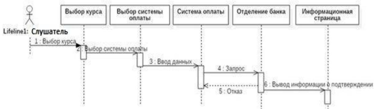
Рисунок 3.10 – Диаграмма последовательности для оплаты курсов безналичным расчетом в модуле «Система оплаты»
