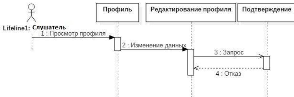
Рисунок 3.4 – Диаграмма последовательности для редактирования профиля слушателя в модуле «Профиль»
