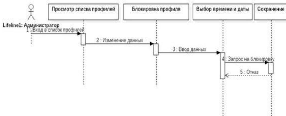
Рисунок 3.8 – Диаграмма последовательности для блокировки профиля администратором в модуле «Управление учетными записями»
