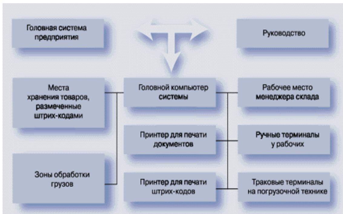
Рисунок 8 – Структурная схема системы управления складом
