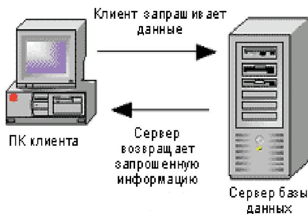
Рис. 3.1 Структурная схема АИС с двухзвенной архитектурой «клиент-сервер».
