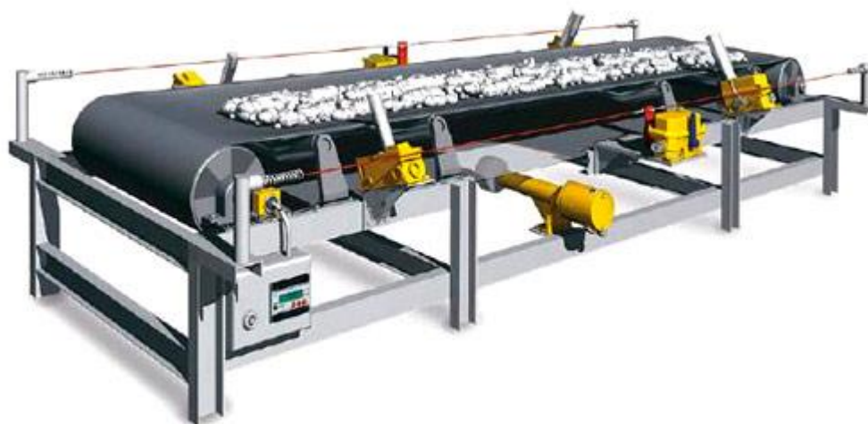
Рисунок 3.2 – Схема установки аварийных тросовых выключателей
