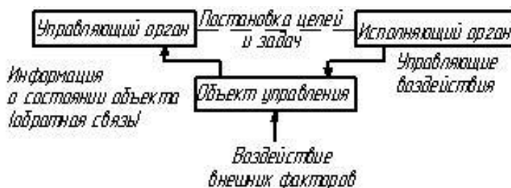
Рисунок 4.1 – Общая схема системы управления
