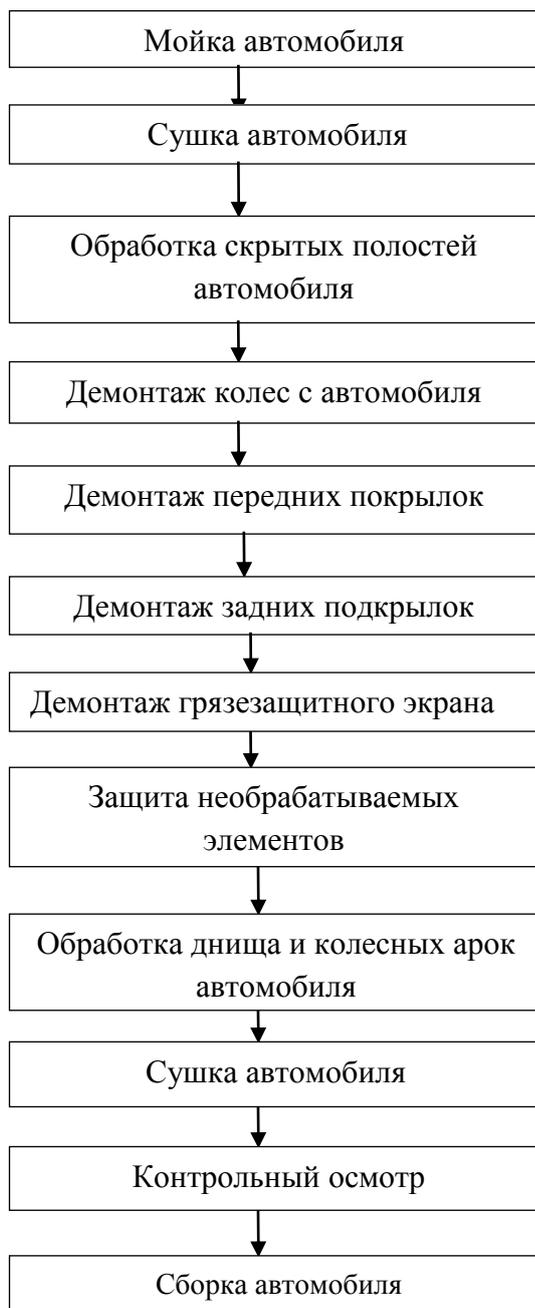
Рисунок 1 – технологический процесс антикоррозийной обработки автомобиля.
