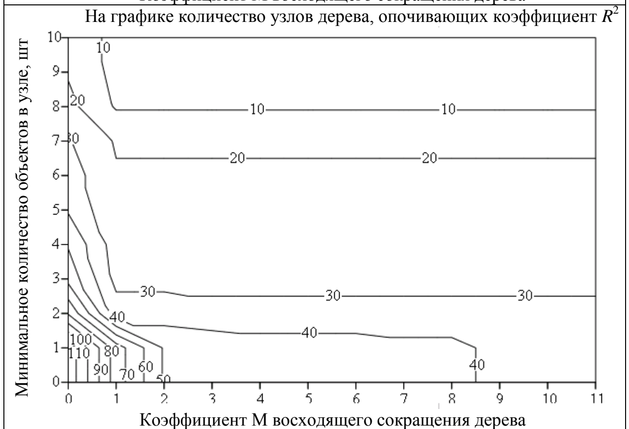
Рисунок 3.8 – Изменение значения коэффициент детерминации R^2 в зависимости от параметров построения дерева и количества узлов
