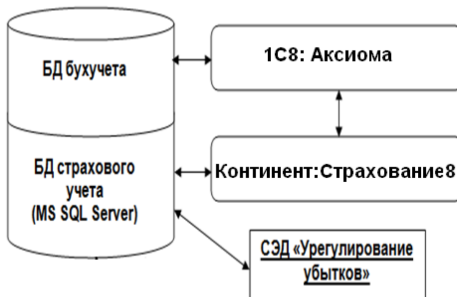
Рисунок 1.2 Структурная схема КИС МРД АО «СК «Астро-Волга»
