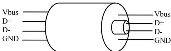
Рис. 13. Сигнальные провода USB
