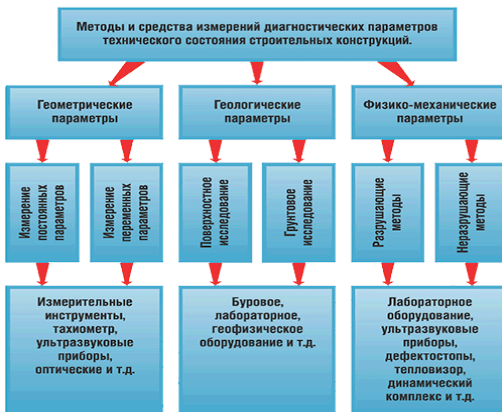
Рисунок 9 – Блок-схема измерений технического состояния конструкций
