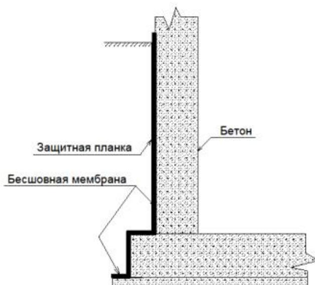
Рисунок 8- Схема нанесения жидкой бесшовной мембраны
