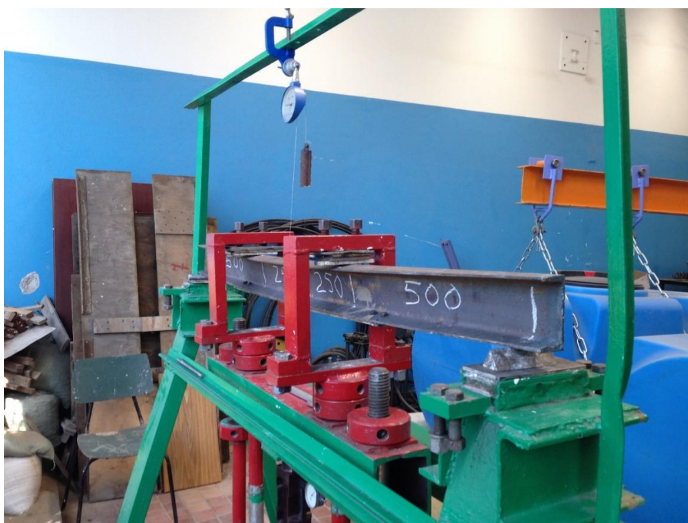
Рисунок Б5 – Вид балки с усилением полосой после испытания.
