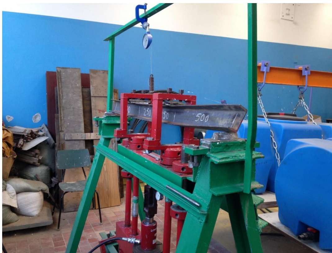
Рисунок Б4 – Вид эталонной балки после испытания. Вид сбоку.
