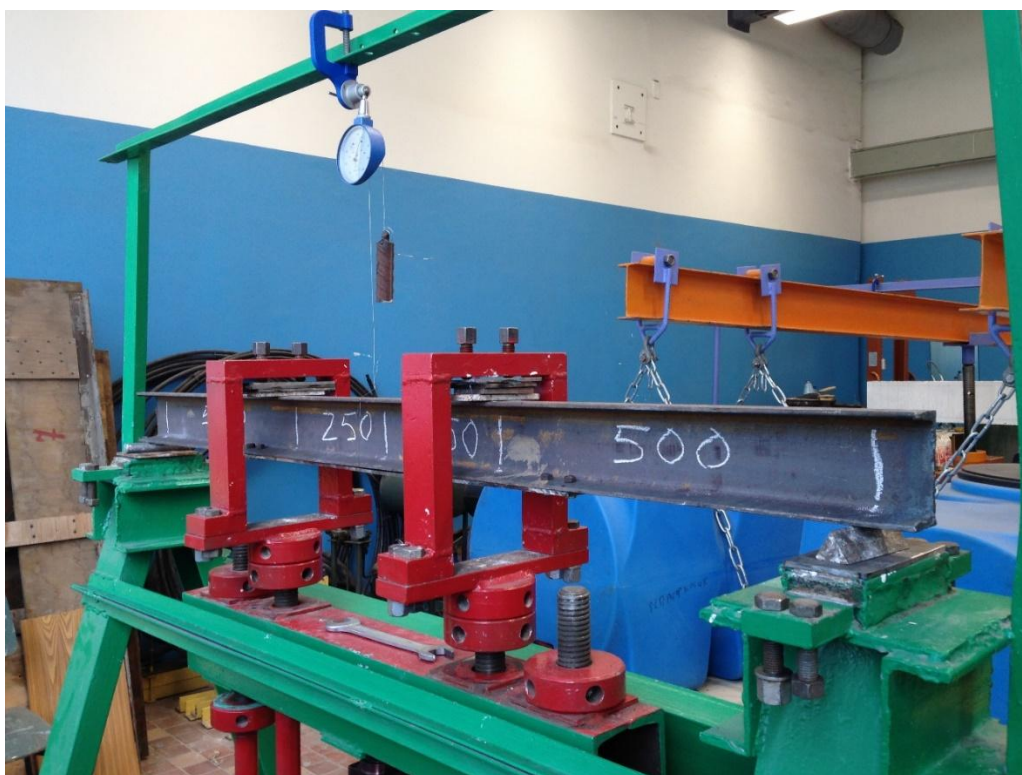
Рисунок Б4 – Вид балки с усилением полосой до испытания.
