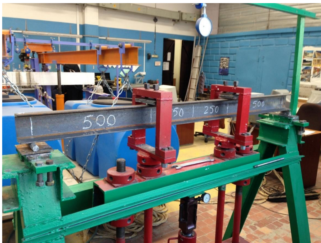
Рисунок Б2 – Вид эталонной балки до испытания.
