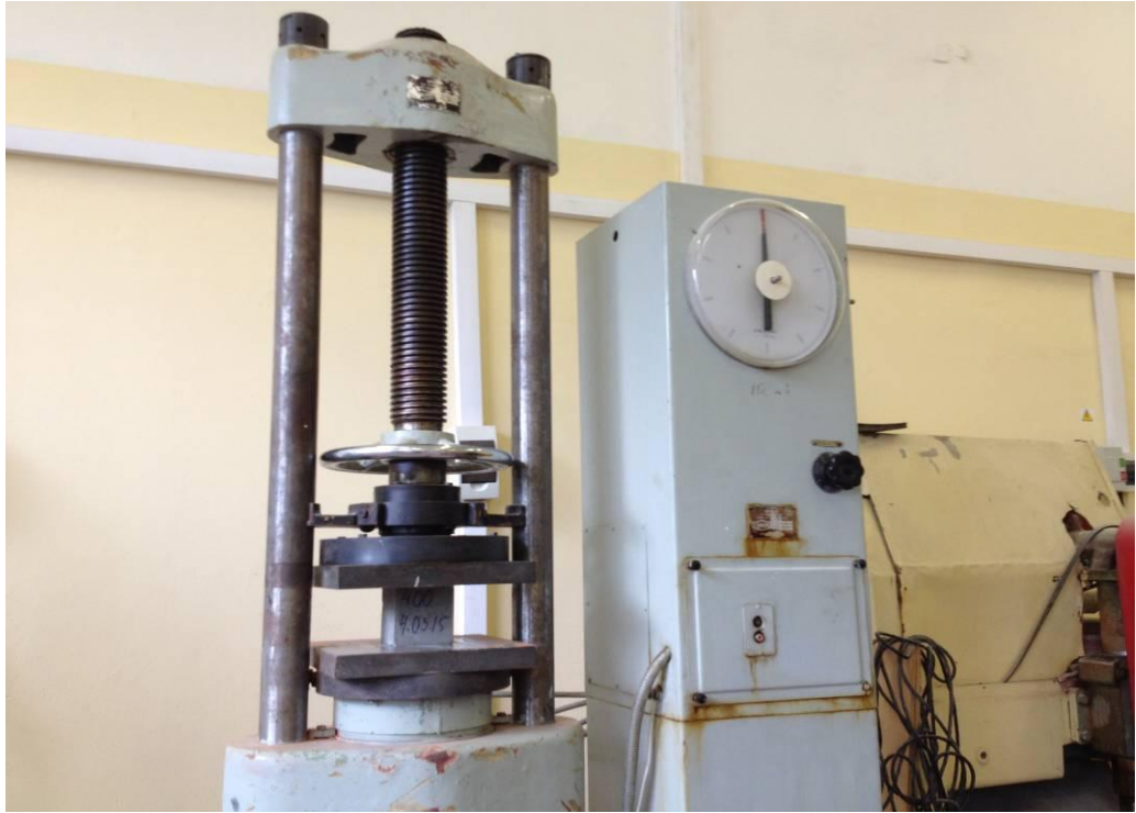
Рисунок 2.11 – Общий вид установки для испытания бетонных кубиков
