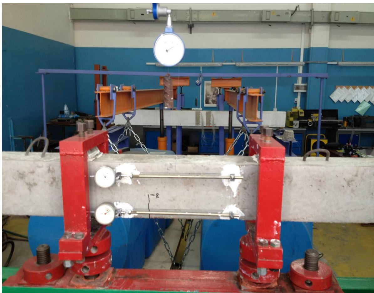
Рисунок 2.21 – Момент образования трещин
