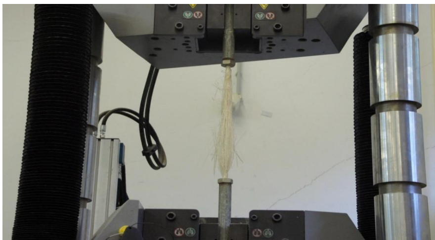
Рисунок 2.14 – Образец стеклопластиковой арматуры в разрывной машине после испытания
