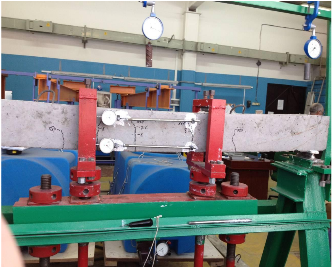
Рисунок 2.23 – Потеря несущей способности
