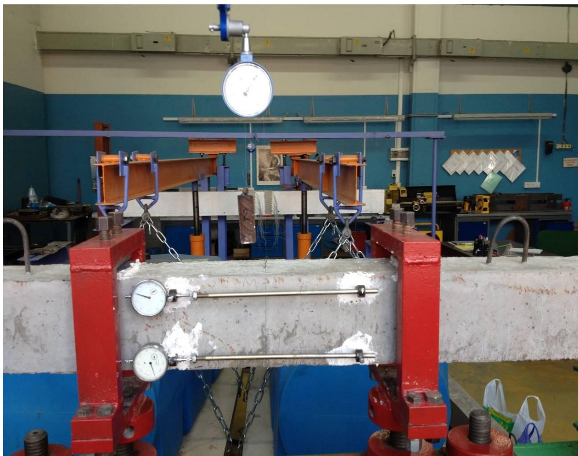
Рисунок 2.20 – Распределительная нагрузочная траверса испытательного стенда
