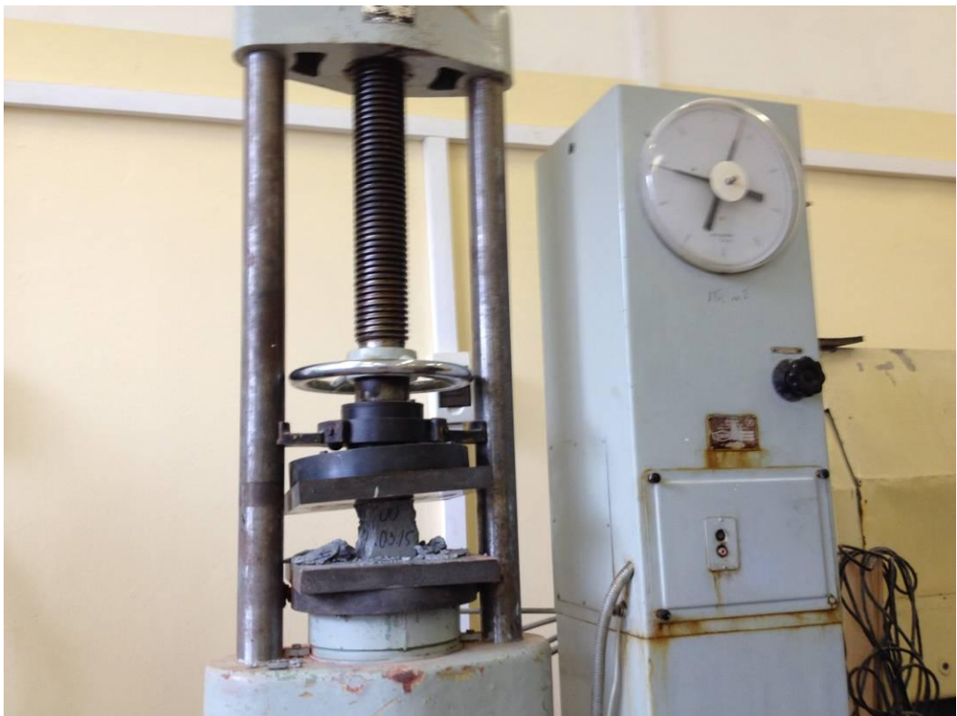
Рисунок 2.12 – Установка после разрушения опытного образца
