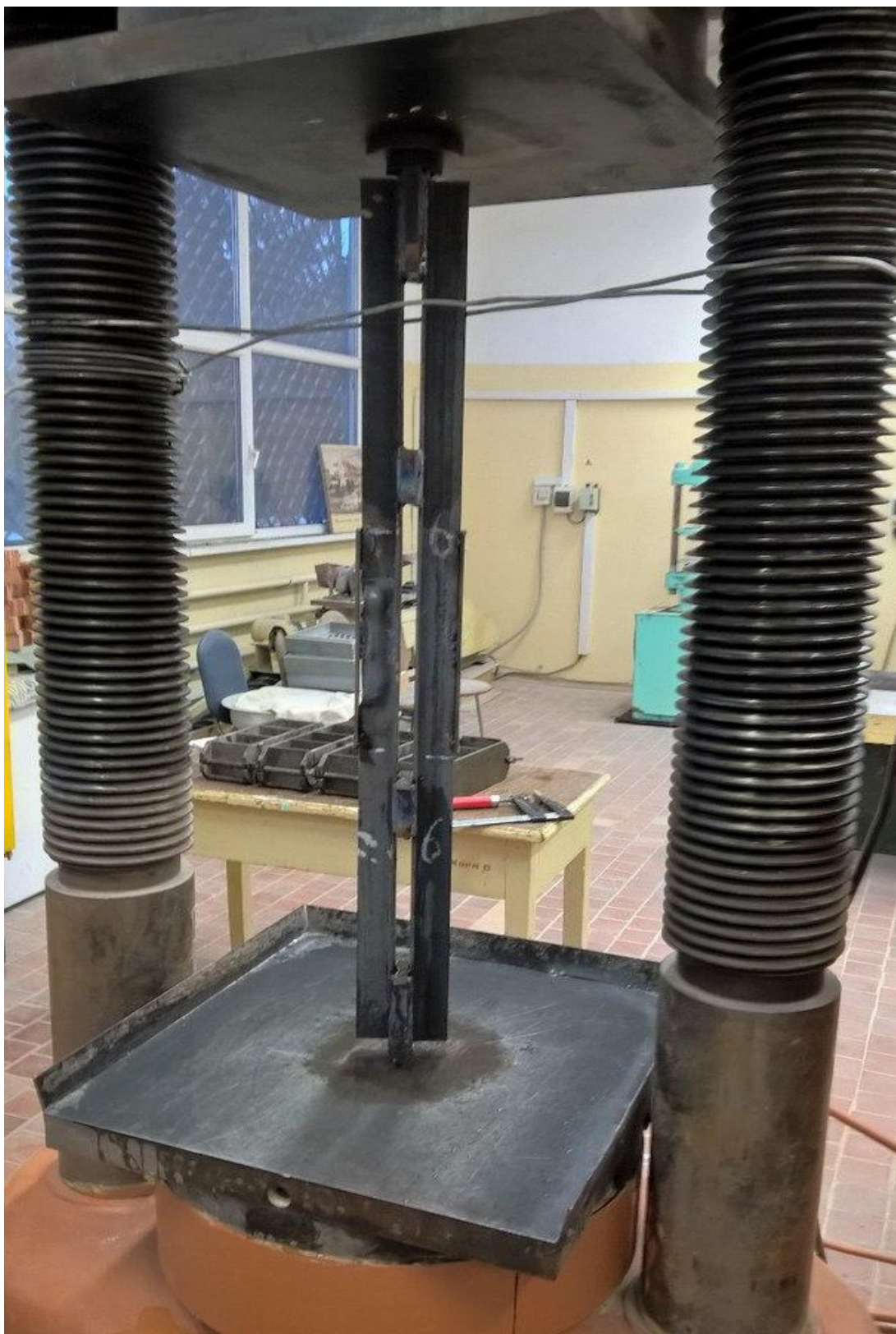
Рисунок В2 – деформированный стержень после присоединения усиливающего элемента
