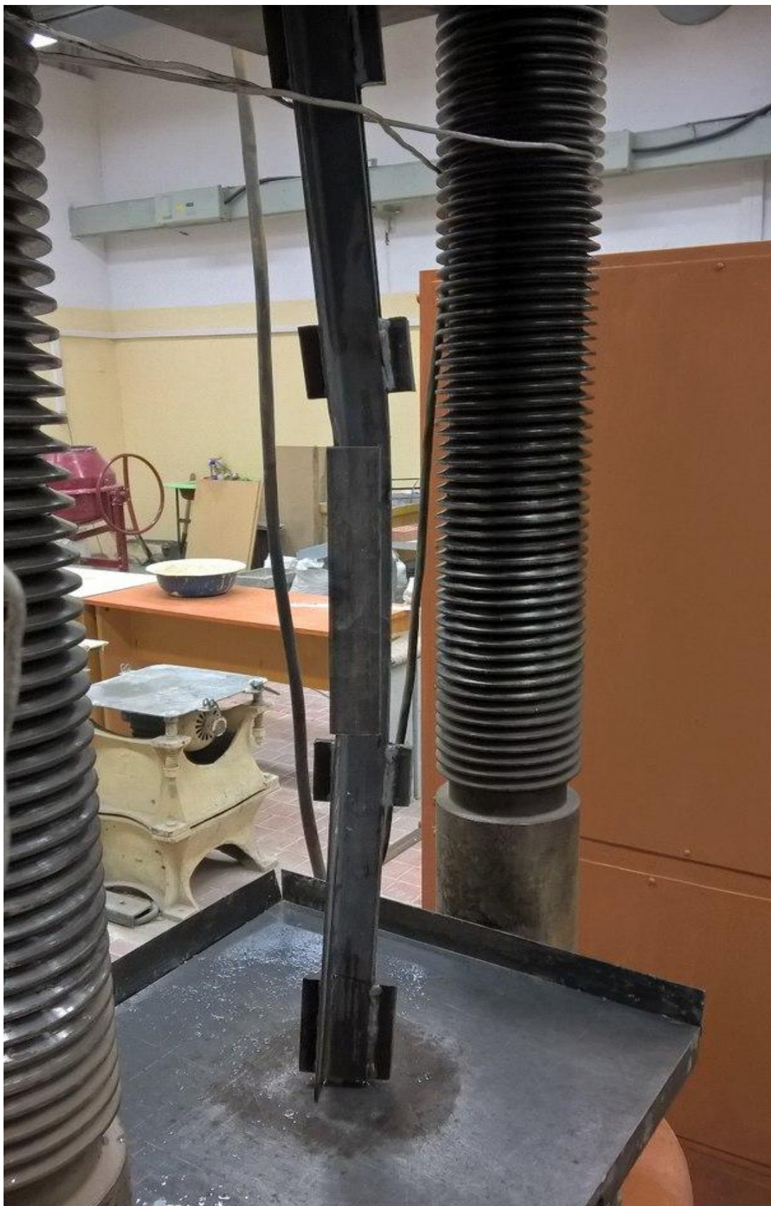
Рисунок Г2 – деформированный стержень, усиленный уголком, после потери устойчивости
