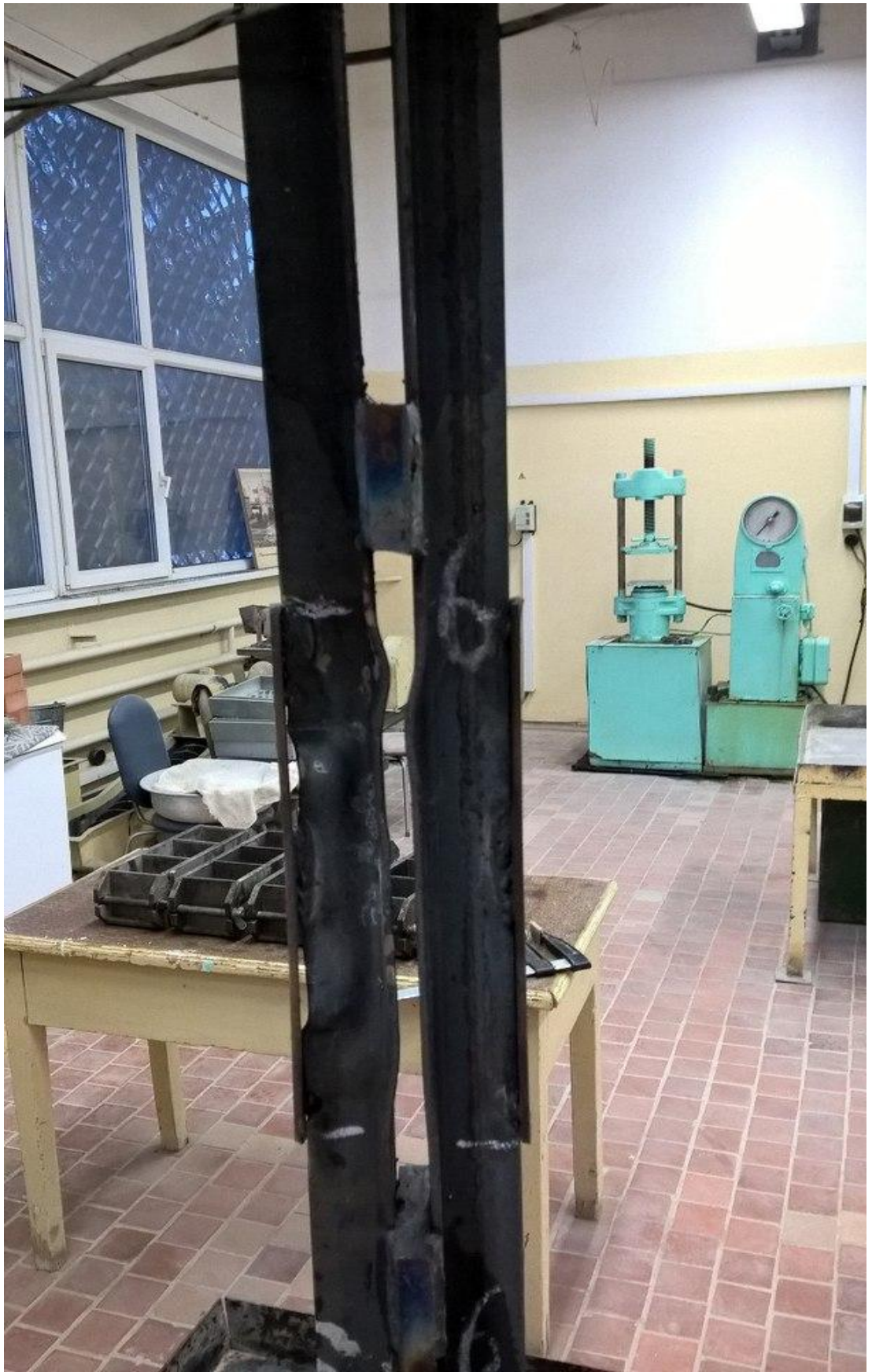
Рисунок В3 – деформированный стержень после потери устойчивости
