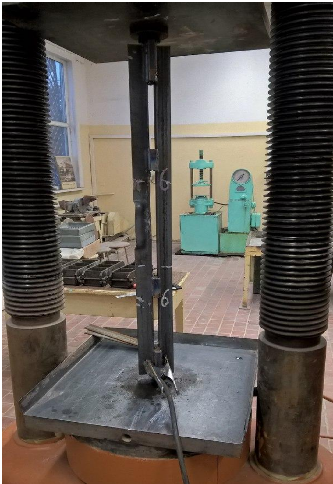
Рисунок В1 – деформированный стержень до присоединения усиливающего элемента
