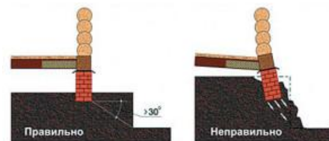
Рисунок 3.8. Ленточный фундамент на склоне
