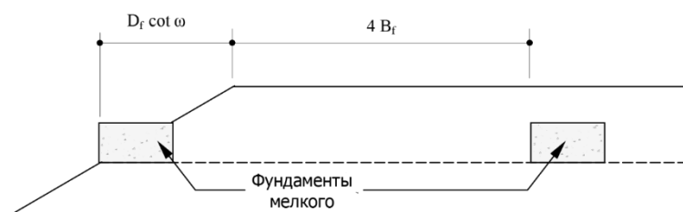
Фундаменты на краю склона и на расстоянии 4B_f от гребня склона
