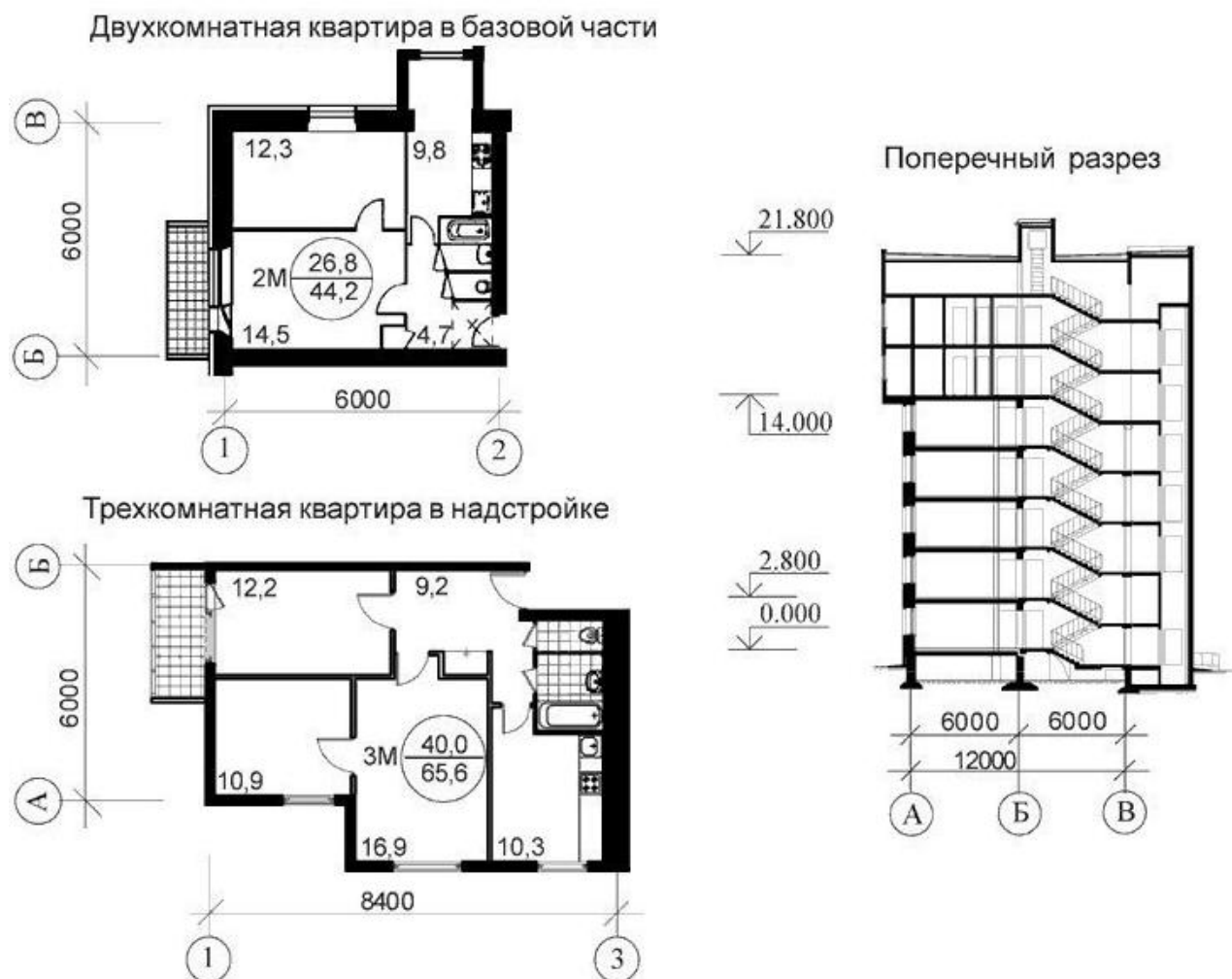
Рисунок Б2 – Проект перепланировки 2- и 3-комнатной квартиры серии дома 1-447
