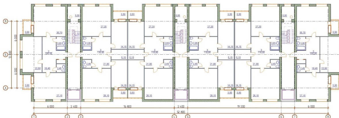
Рисунок 37 – Проект реконструкции серии 1-447. Мансардный этаж
