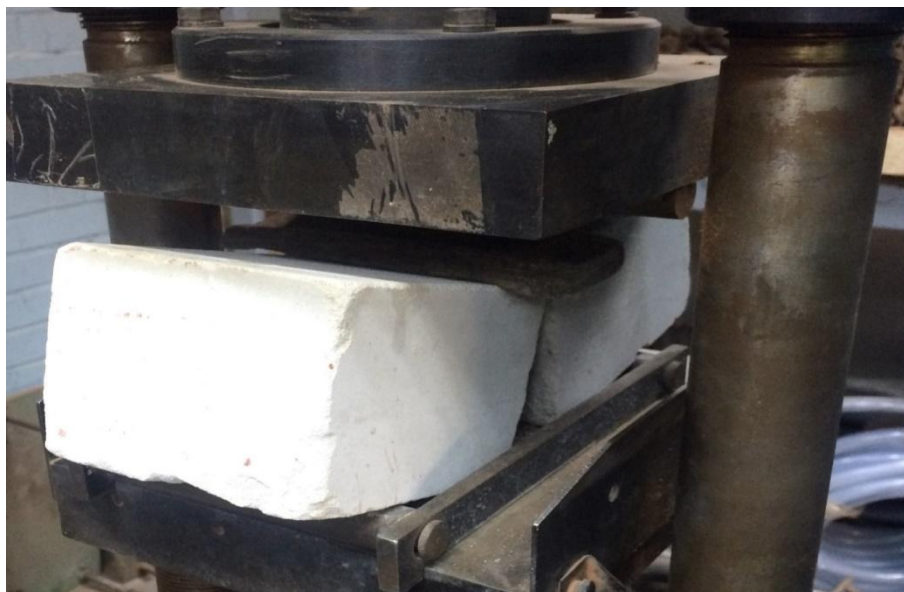
Рисунок 3.7 - Определение прочности силикатного кирпича
