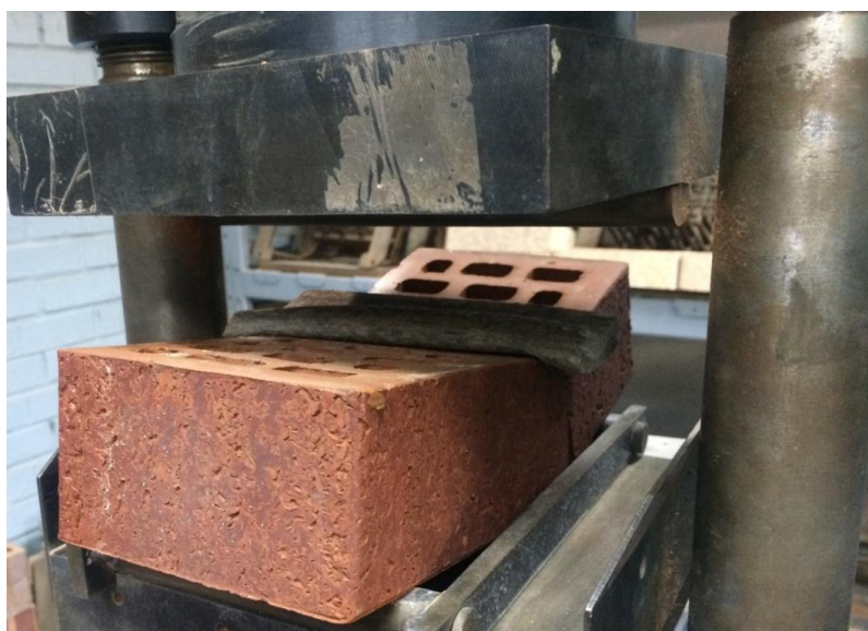
Рисунок 3.6 - Определение прочности керамического кирпича
