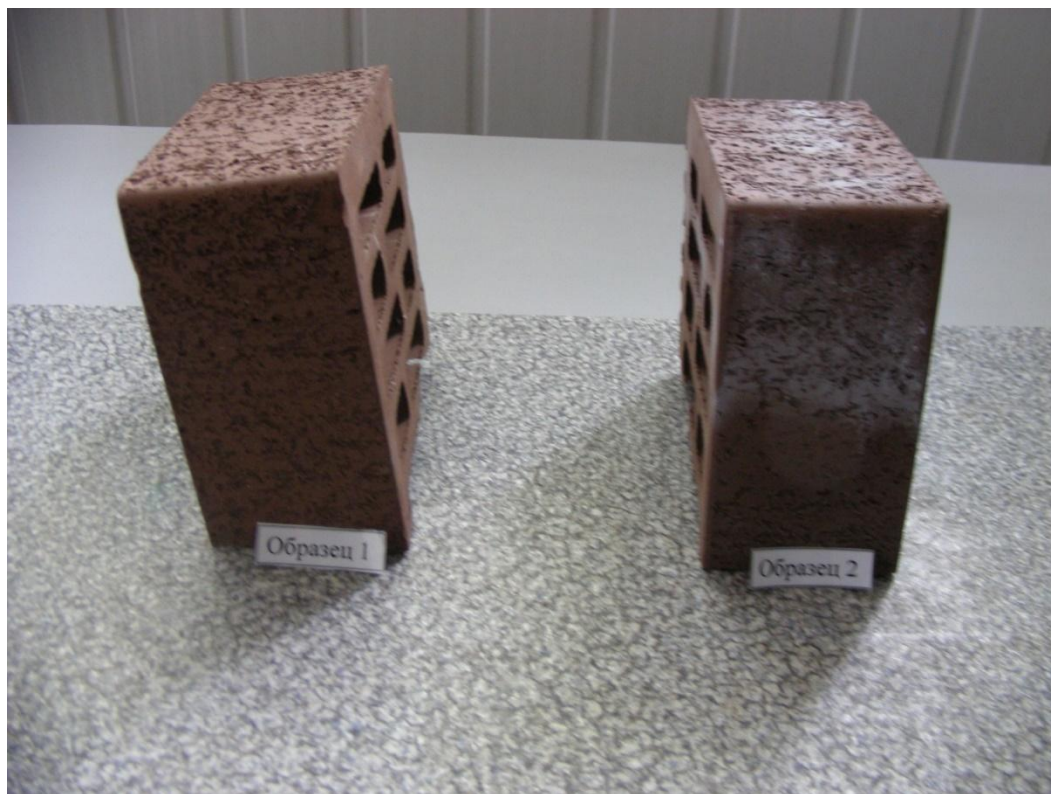
Рисунок 3.5 - Образование высолов на лицевой поверхности керамического кирпича
