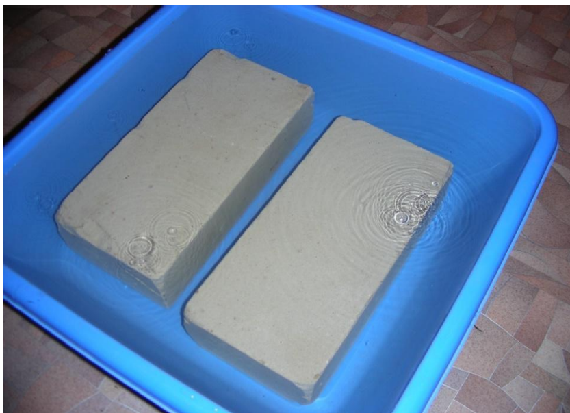
Рисунок 3.4 - Определение влагопоглощения силикатного кирпича
