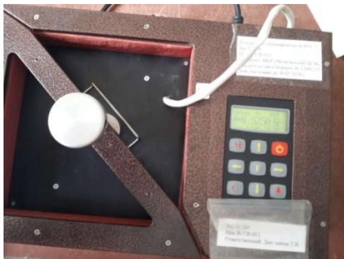
Рисунок 1.6. Исследование пластины на теплопроводность
