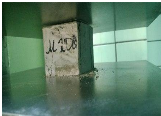
Рисунок 2.8 – Характер разрушения опытных образцов.
