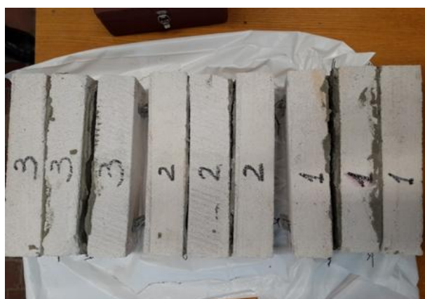
Рисунок 2.12 – Общий вид образцов на клеевом растворе для испытания на прямой отрыв
