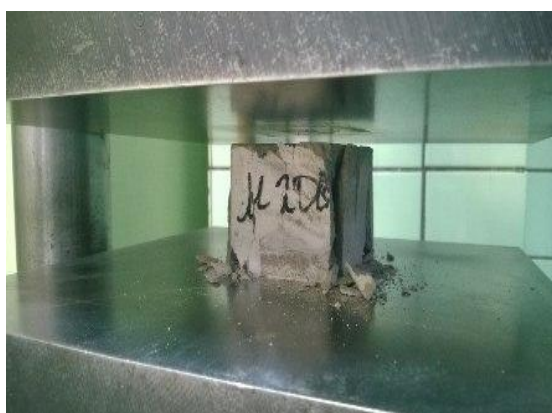
Рисунок 2.9 – Характер разрушения опытных образцов.
