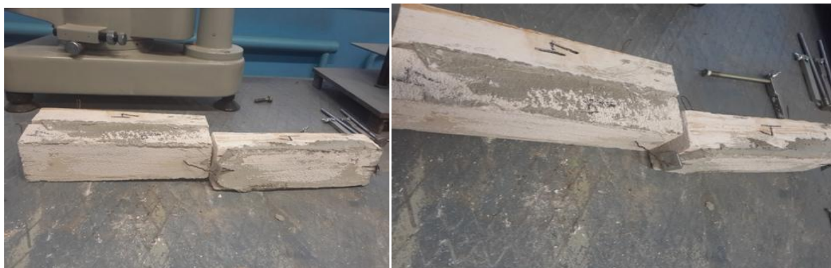
Рисунок 2.20 – Характер разрушения образца №4 на цементно-песчаном растворе
