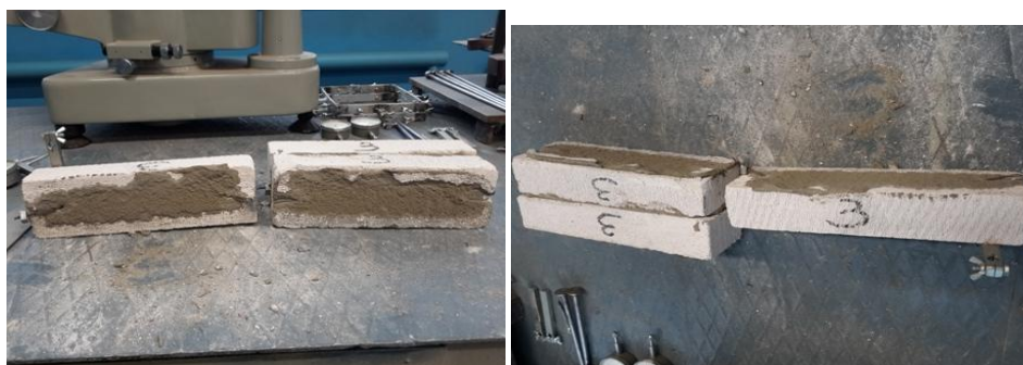
Рисунок 2.19 – Характер разрушения образца №3 на клеевом растворе.
