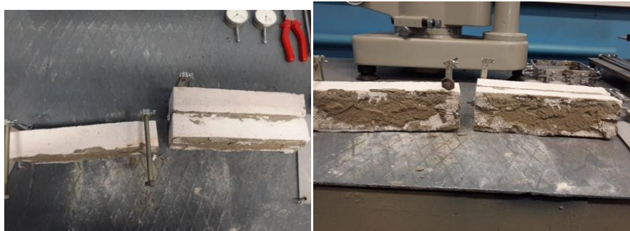
Рисунок 2.17 – Характер разрушения образца №1 на клеевом растворе.
