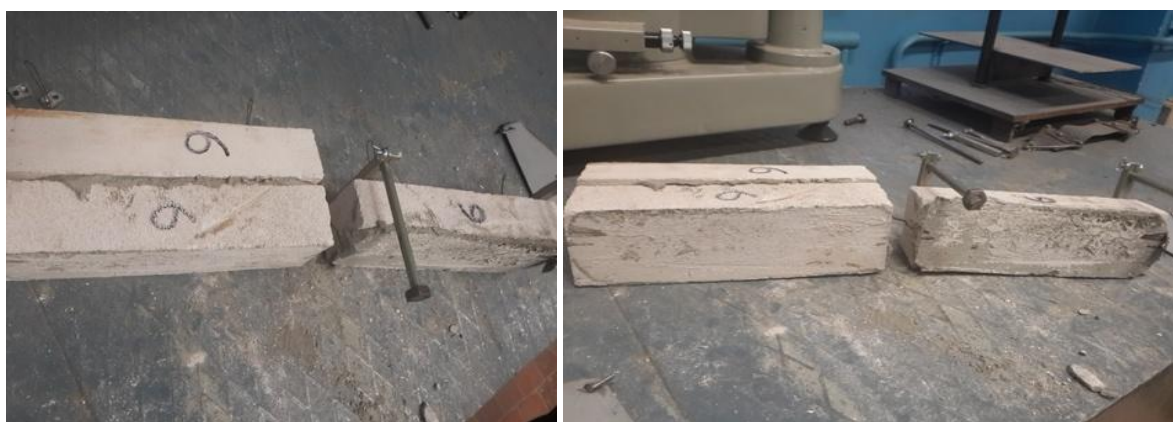
Рисунок 2.22 – Характер разрушения образца № 6 на цементно-песчаном растворе
