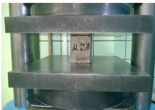
Рисунок 2.6 – Опытный образец (куб из цементно-песчаного раствора) перед началом испытания
