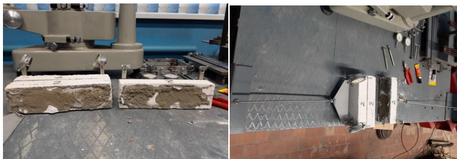
Рисунок 2.18 – Характер разрушения образца №2 на клеевом растворе
