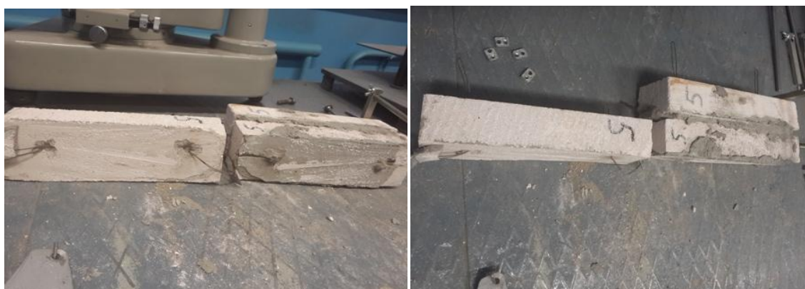
Рисунок 2.21 – Характер разрушения образца №5 на цементно-песчаном растворе
